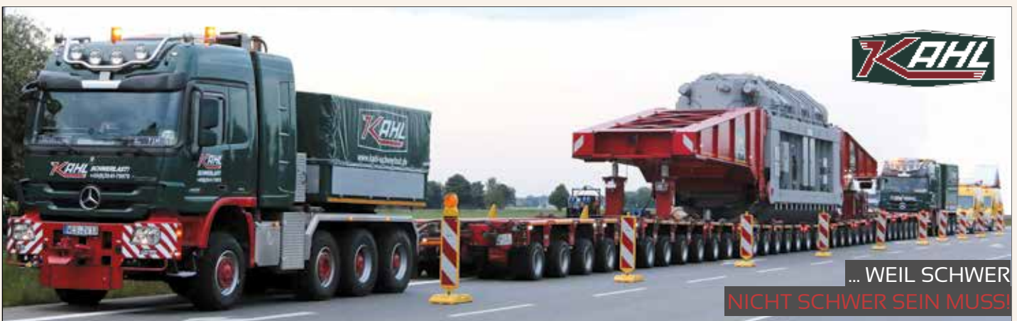
In einer Live-Vorführung wurde dieser 10-achsige Semitiefelader zu einer 3+5-Tiefbettkombination umgebaut. STM-Bild
