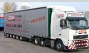
3- bis 5-Achs-Jumbo-Satteltiefelader, verbreiterbar und anhebbar
