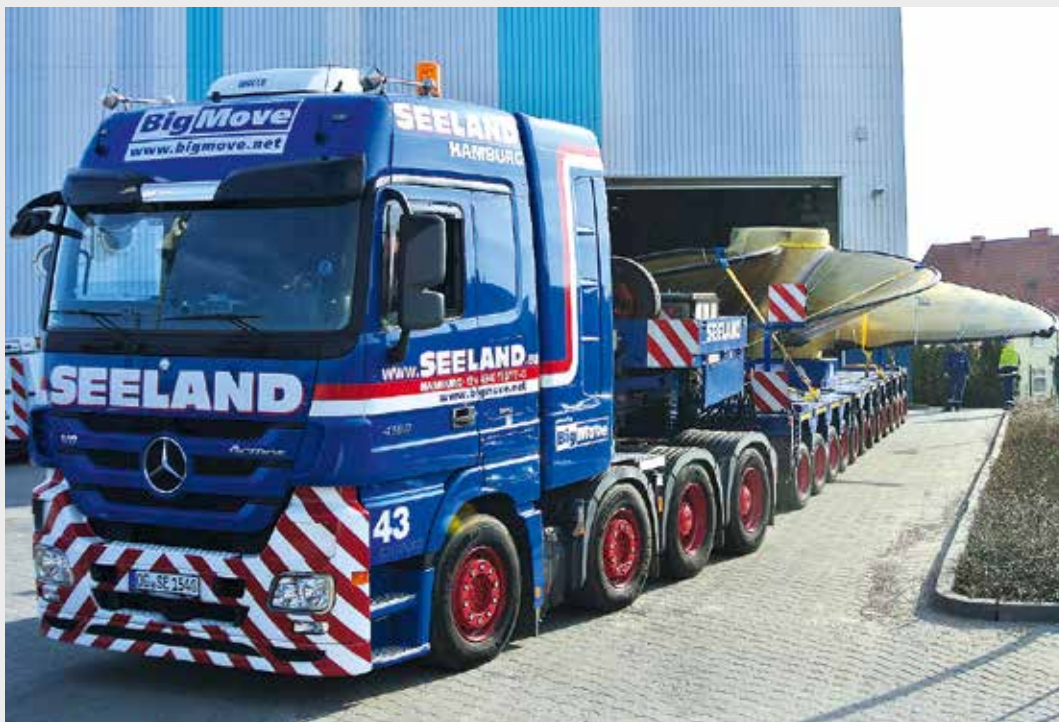
Auf ein Gesamtgewicht von 125 t brachte es dieser Schwertransport, dem es leicht gemacht wurde.
