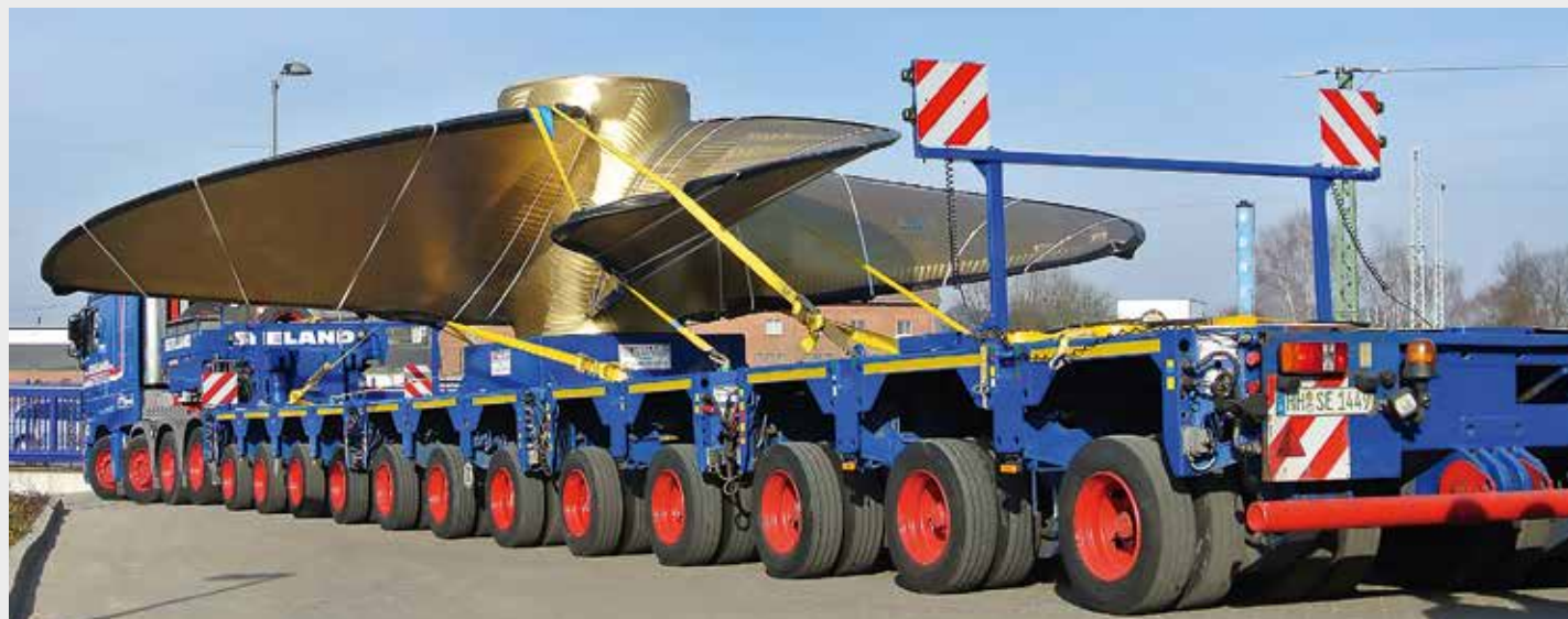
Beachtlich: 9 m Durchmesser misst die zu transportierende Schiffsschraube.
