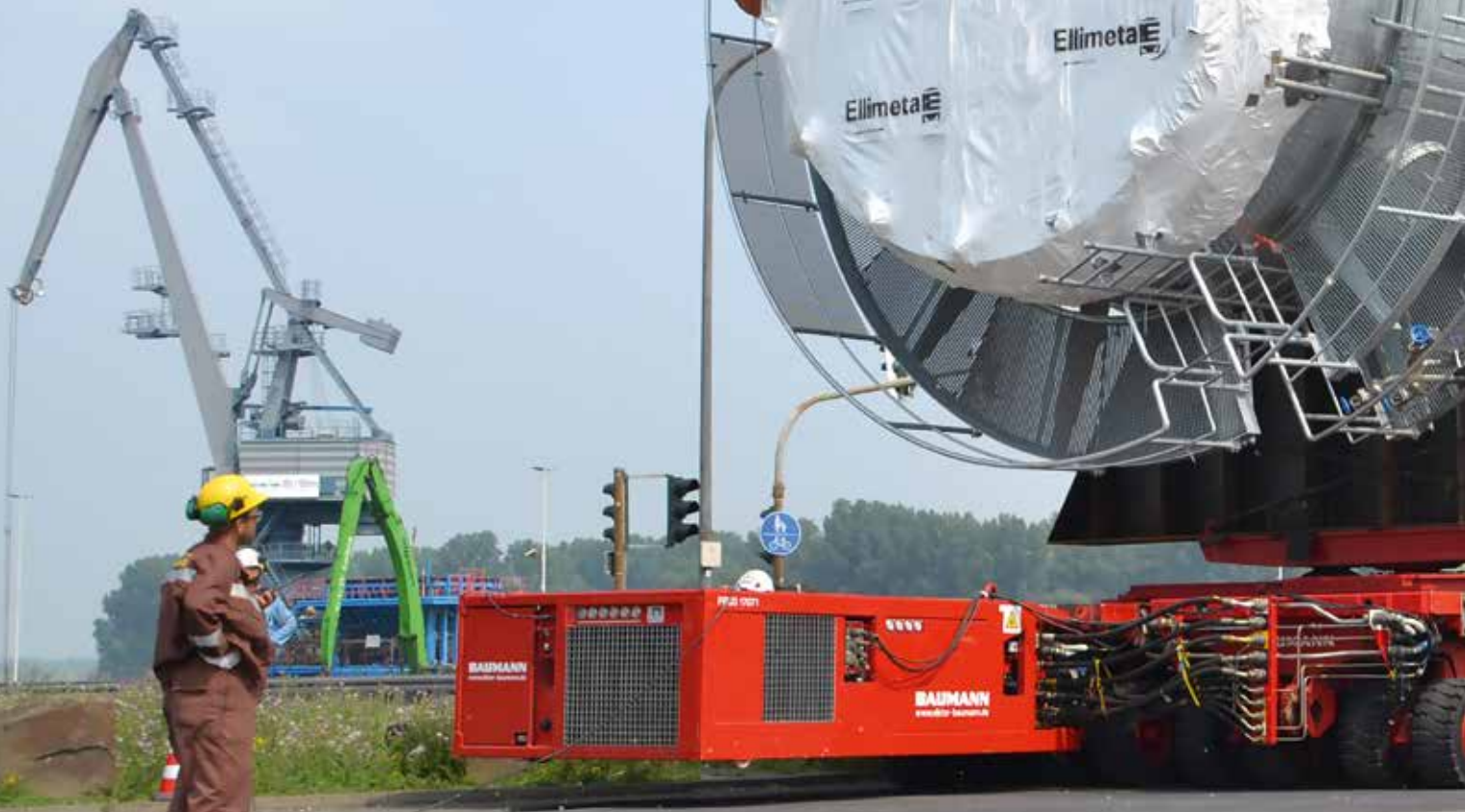
Auf der einen Seite 8 Achslinien SPMT, auf der anderen zwei quergekoppelte SPMTs mit jeweils 6 Achslinien: so ging es vom Hafen ins Werk.
