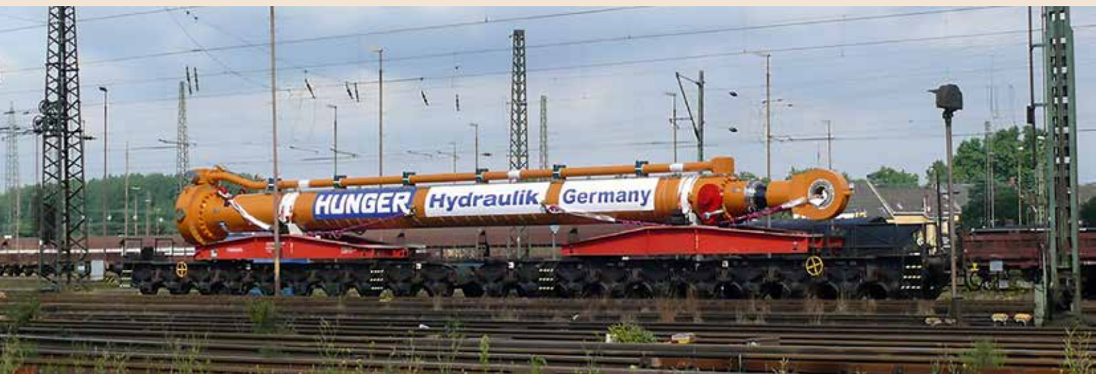
Auf dem 20-achsigen Schienentiefadewagen der Bauart Uaai 836 geht es von Lohr nach Rotterdam.
