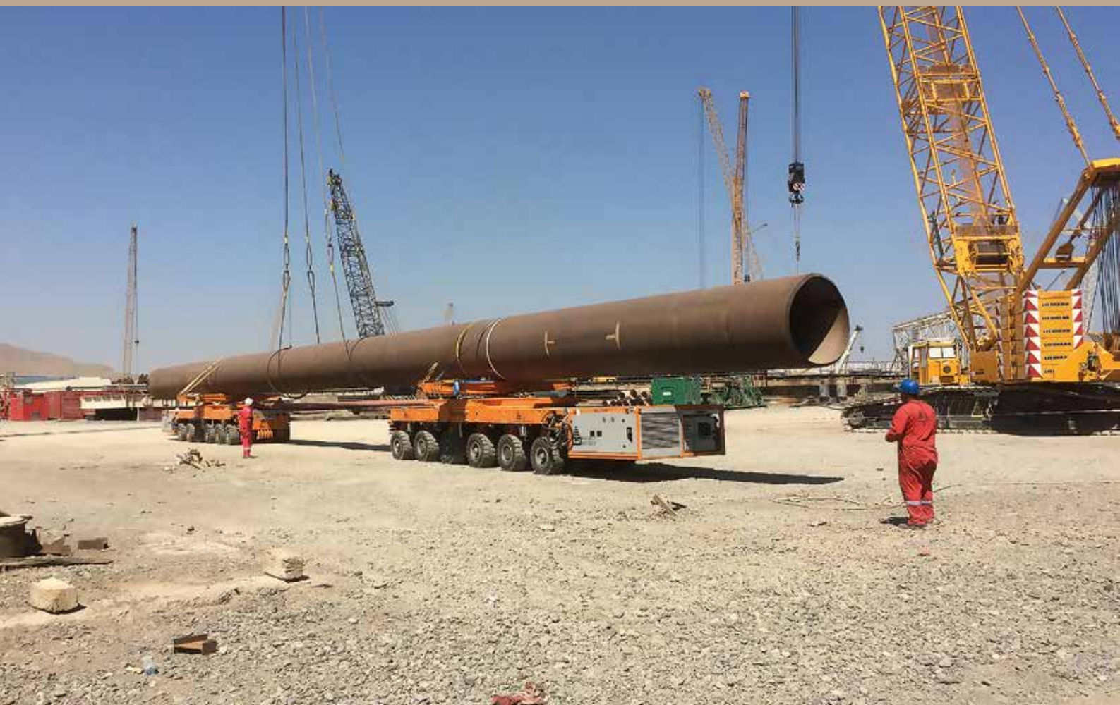
Transport riesiger Rohre mit dem K24 von Kamag auf dem Firmengelände, wobei Schemel mit einer Nutzlast von 300 t zum sicheren Fixieren der Ladung zum Einsatz kommen.
