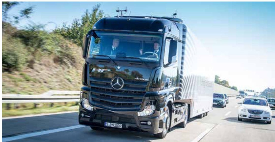
Premierenfahrt des ersten automatisiert fahrenden Serien-Lkw auf der A8. Wer genau hinsieht erkennt, dass die Hände hier nicht am Steuer sind.
