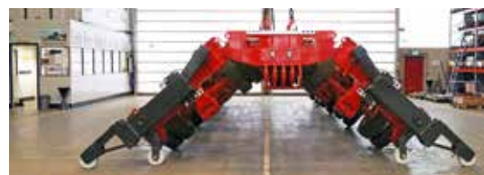
Der Highway Giant verfügt über einen Klappmechanismus.
