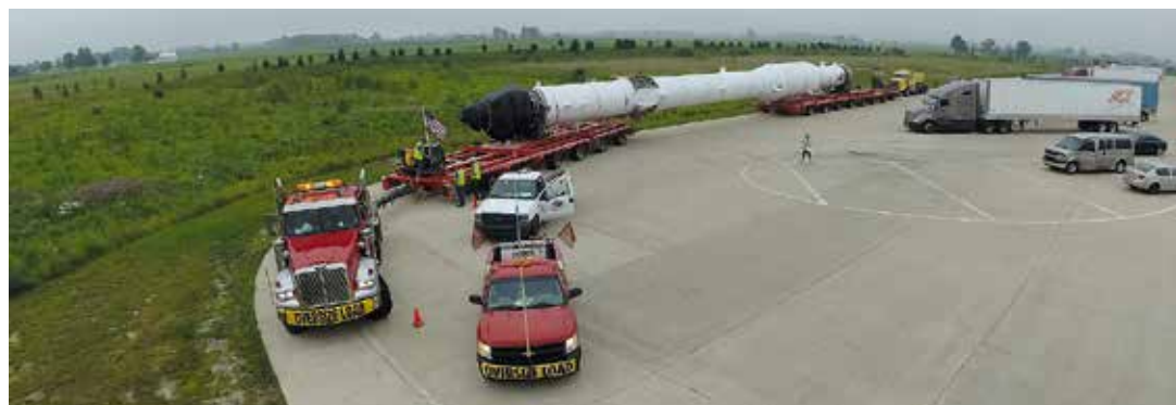
Mit einer Zugmaschine vorne und einer hinten setzte sich die Kombination nach Beendigung des Ladevorgangs in Bewegung.
