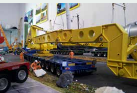
Rüsten einer Transportbrücke.
