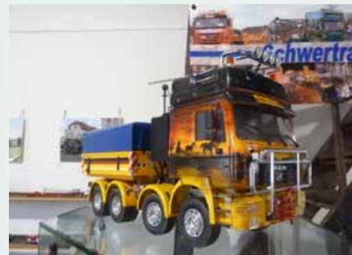
Fett, bunt: 8x4/4-Zugmaschine mit zwei gelenkten Vorderachsen.
