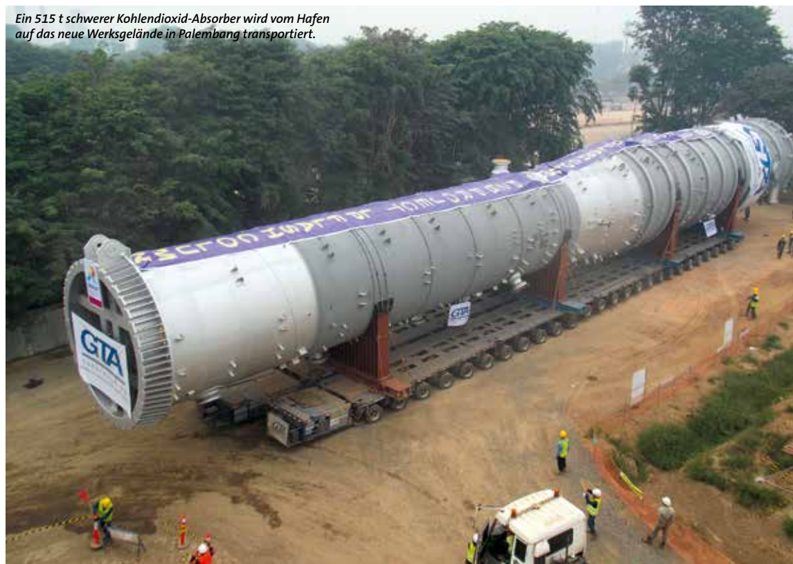
Beladung der Goldhofer Selbstfahrer mit einem Teilstück der Gas-Fraktionierungsanlage
