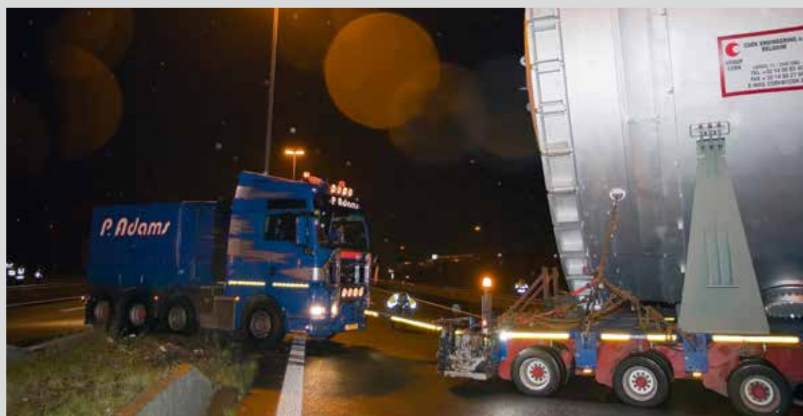
Eine 4-achsige Schwerlastzugmaschine wird als Schubfahrzeug angekuppelt, damit auch der nicht asphaltierte Mittelstreifen problemlos bewältigt werden kann.
