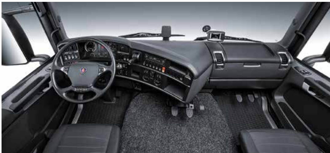
Mehr Sitze und zusätzliche Pedale sind die auffälligsten Merkmale des Fahrschul-Lkw.
