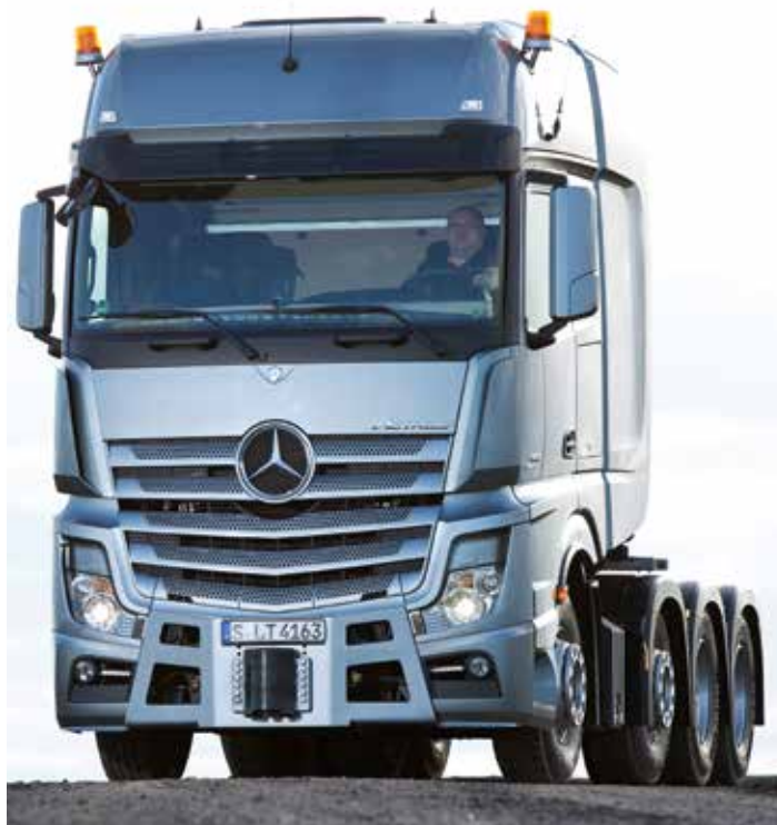
Der auf der bauma ausgestellte Actros 4163 LS Semi-SLT ist ein eher mittelschwerer SLT-Vertreter, der per zusätzlicher Andockachse zum 5-Achser wird.
