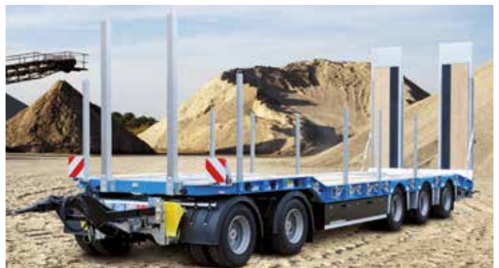
Die Anhänger der Modellreihe HTD und HTS sind für den Transport schwerer Baumaschinen konzipiert.
