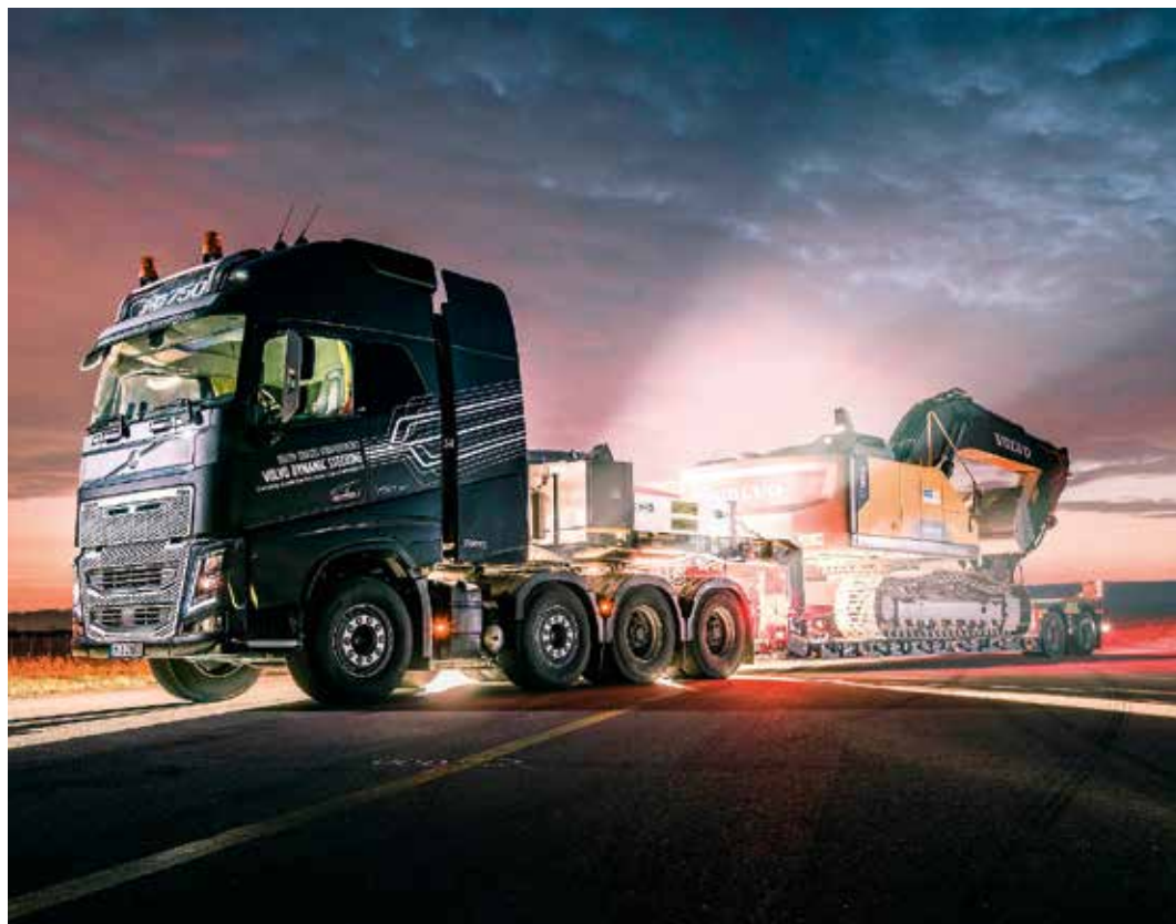
In Hannover mit dabei: FH16 8x4 mit 750 PS-Motor, I-Shift mit zwei Crawler-Gängen und Globetrotter XL Fahrerhaus.
