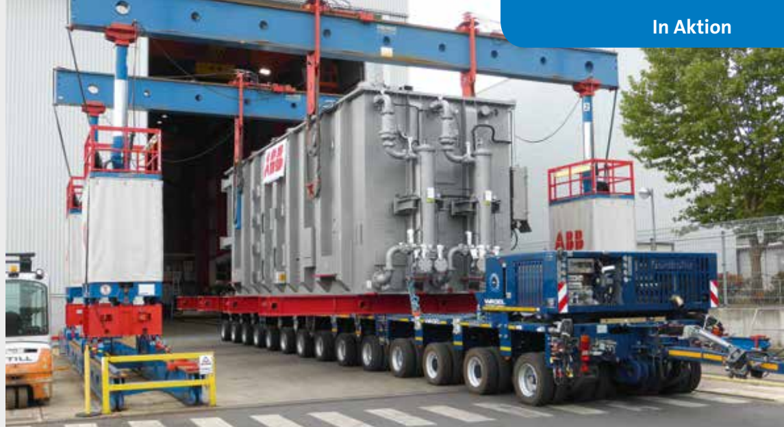
Der 290 t schwere Transformator wird auf die aus 14 Achslinien bestehende Schwerlastkombination geladen. Vorne sieht man den Addrive.
