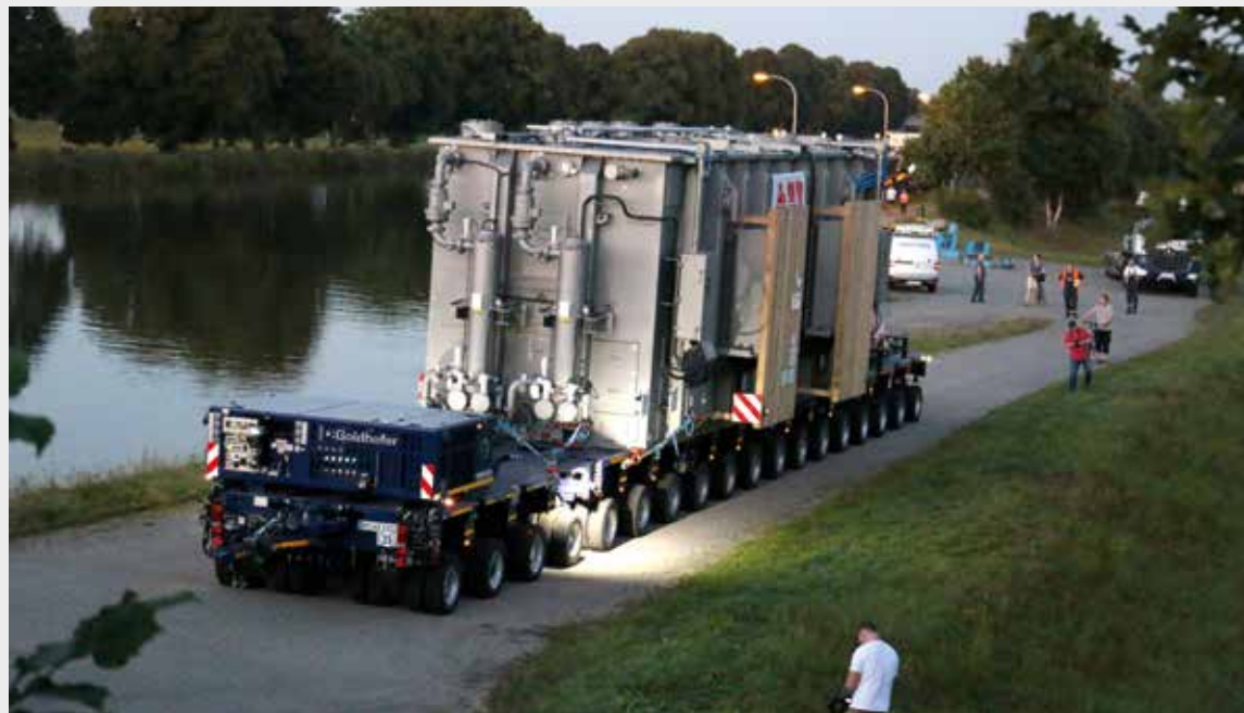
Für den weiteren Transport an Land wurde die Kombination auf 18 Achslinien ausgebaut. Die erste 90° Kehre muss der Addrive alleine bewältigen, weil aufgrund der beengten Platzverhältnisse keine Zugmaschine vorgespannt werden konnte.
