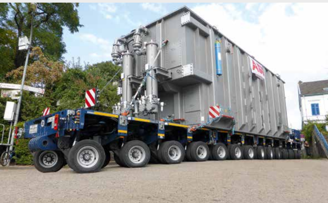
Der Transformator wird zur NATO-Rampe gefahren. Immer wieder musste das 280 PS starke PowerPack nachlenken und das Niveau ausgleichen.
