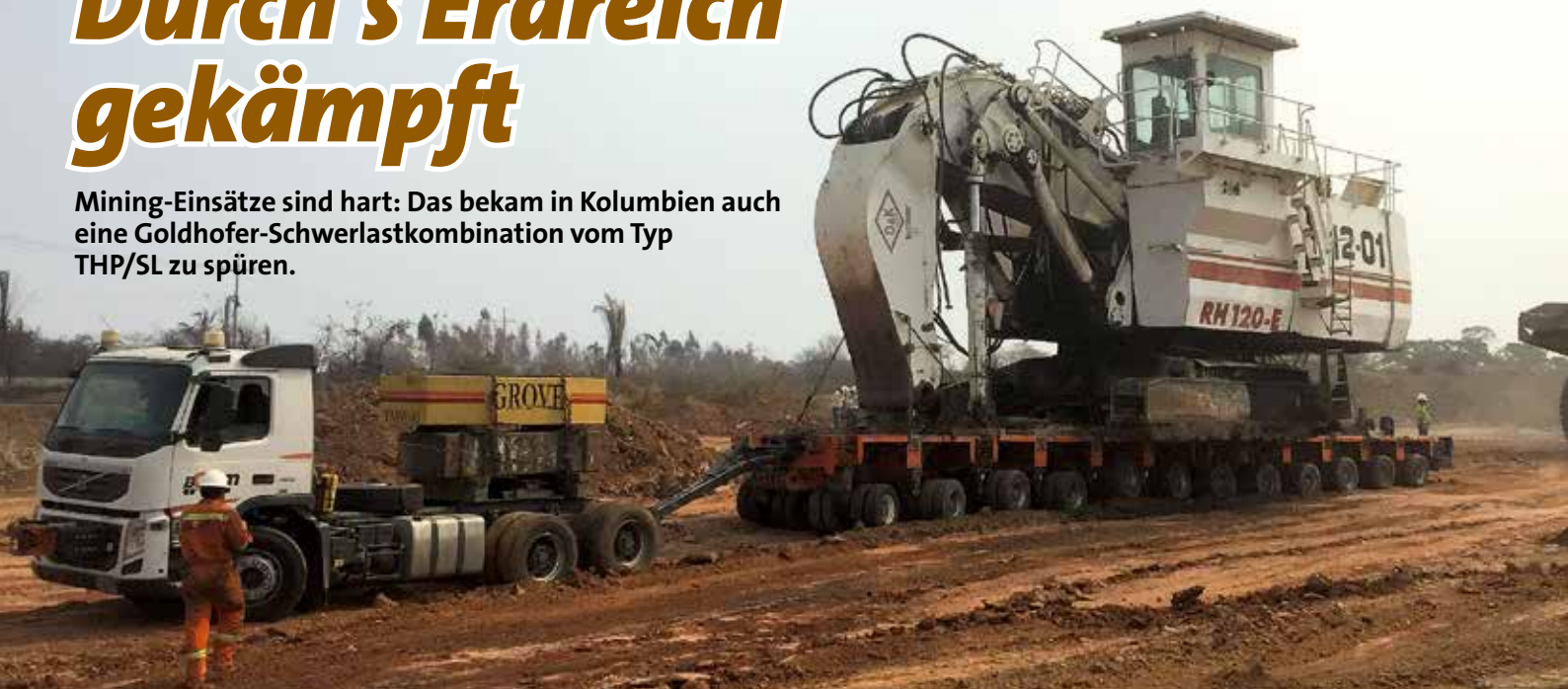
Der THP SL 12 wird mit Hilfe eines Dumpers und einer Zugmaschine vom Minengelände gefahren.
