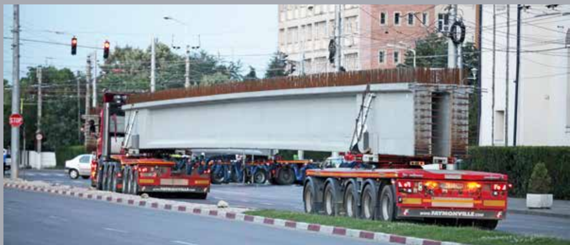
Raumgreifend, aber machbar: einer der Betontransporte meistert gerade eine Rechtsabbiegung.
