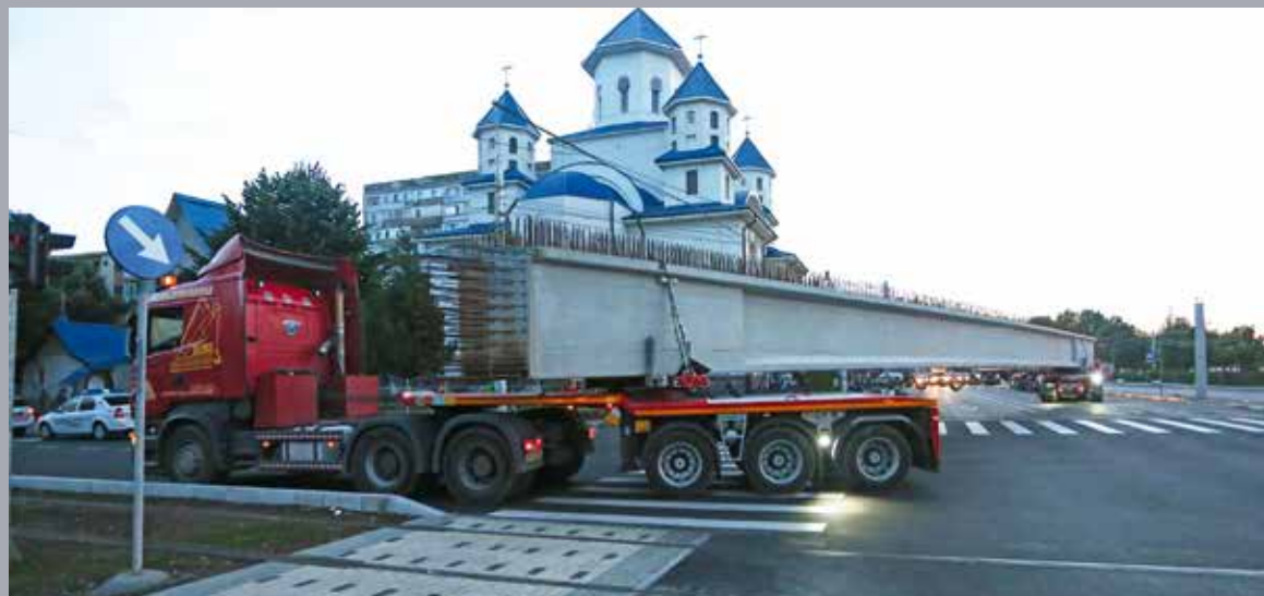
Das rumänische Unternehmen Deme Macarale transportiert auf ihrem FlexMAX von Faymonville bis zu 46 m lange Betonträger.
