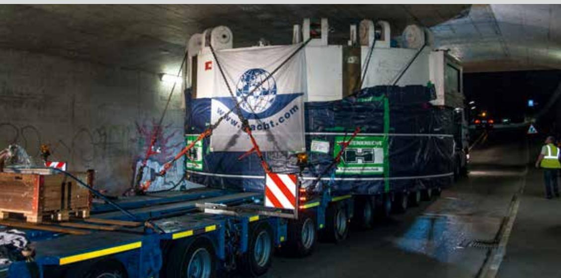
An der Eisenbahnunterführung Schönenwerd sind nur wenige Zentimeter Luft nach oben, obwohl der Auflieger schon abgesenkt ist.
