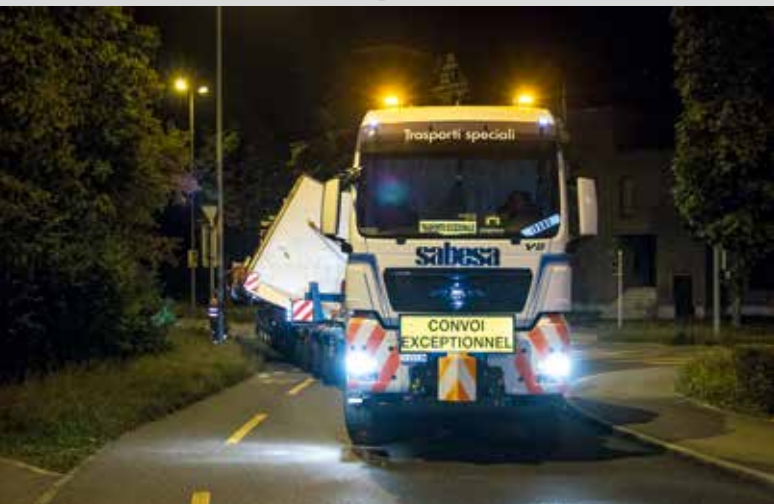
Mit 6,15 m Breite ist das Schildsegment nur etwas schlanker als der Antriebsmotor der Tunnelbohrmaschine, der es auf eine Breite von 6,2 m bringt.
