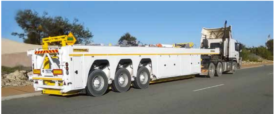
Mit 2.490 mm wurde die Breite der Innenlader auf die australischen Standards angepasst.
