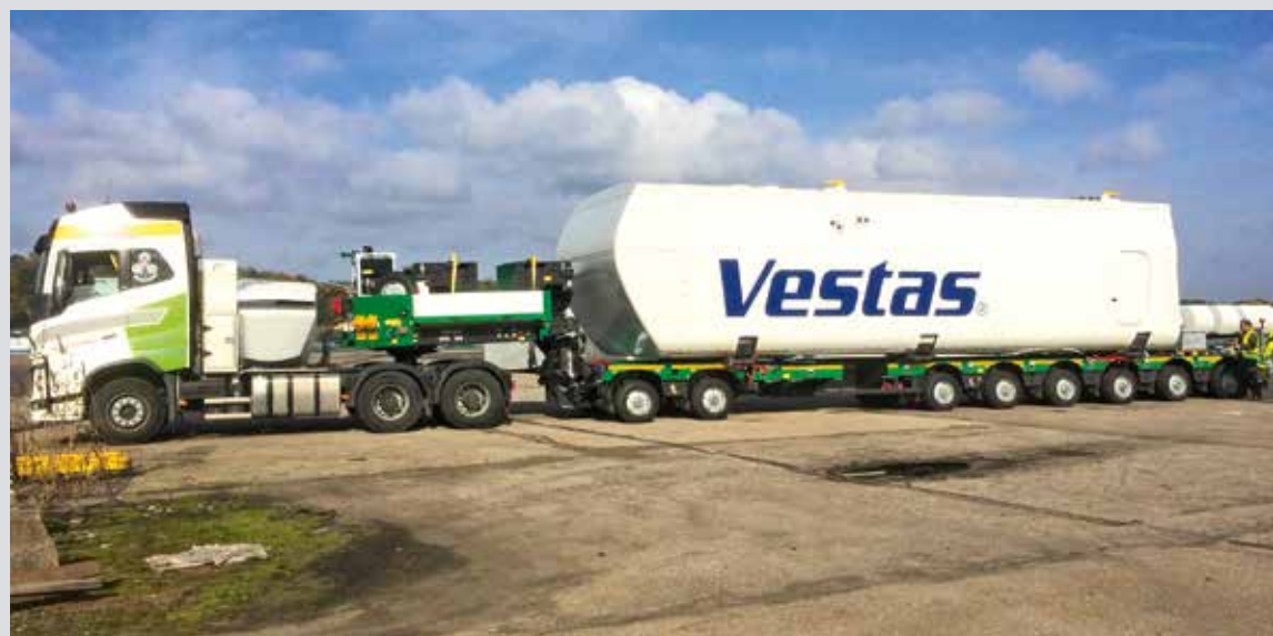
Das französische Unternehmen Rosec Transport setzt auf PA-X-Achsen von Faymonville. Bei einem der ersten Einsätze wurde ein Windanlagengenerator mit einem Gewicht von 80 t und einer Länge von 13 m transportiert.
