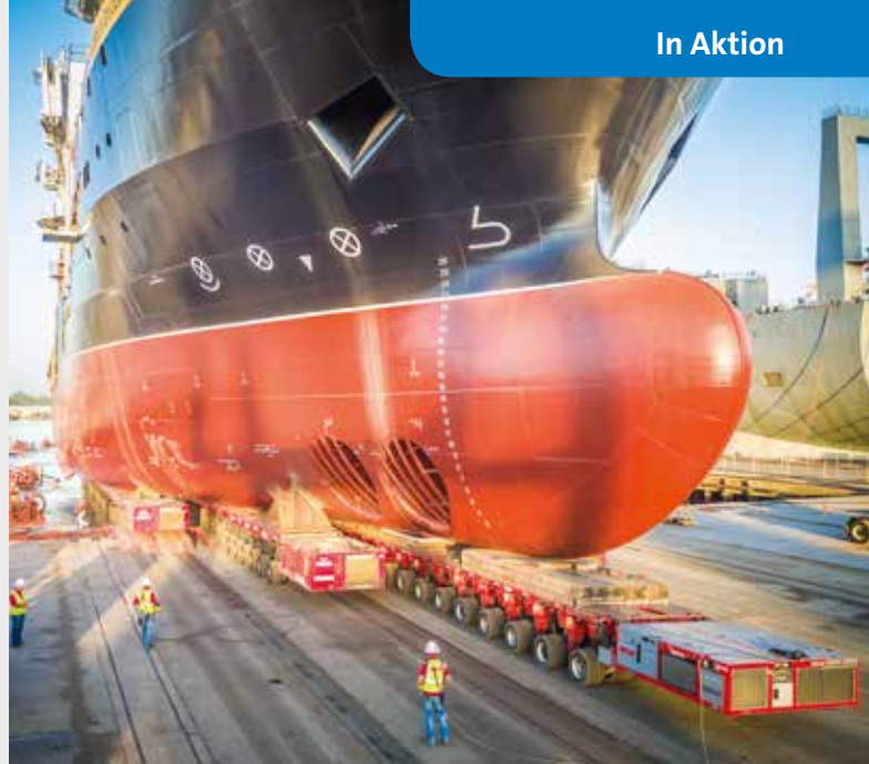
Achslinie für Achslinie rollt auf den Ponton.
