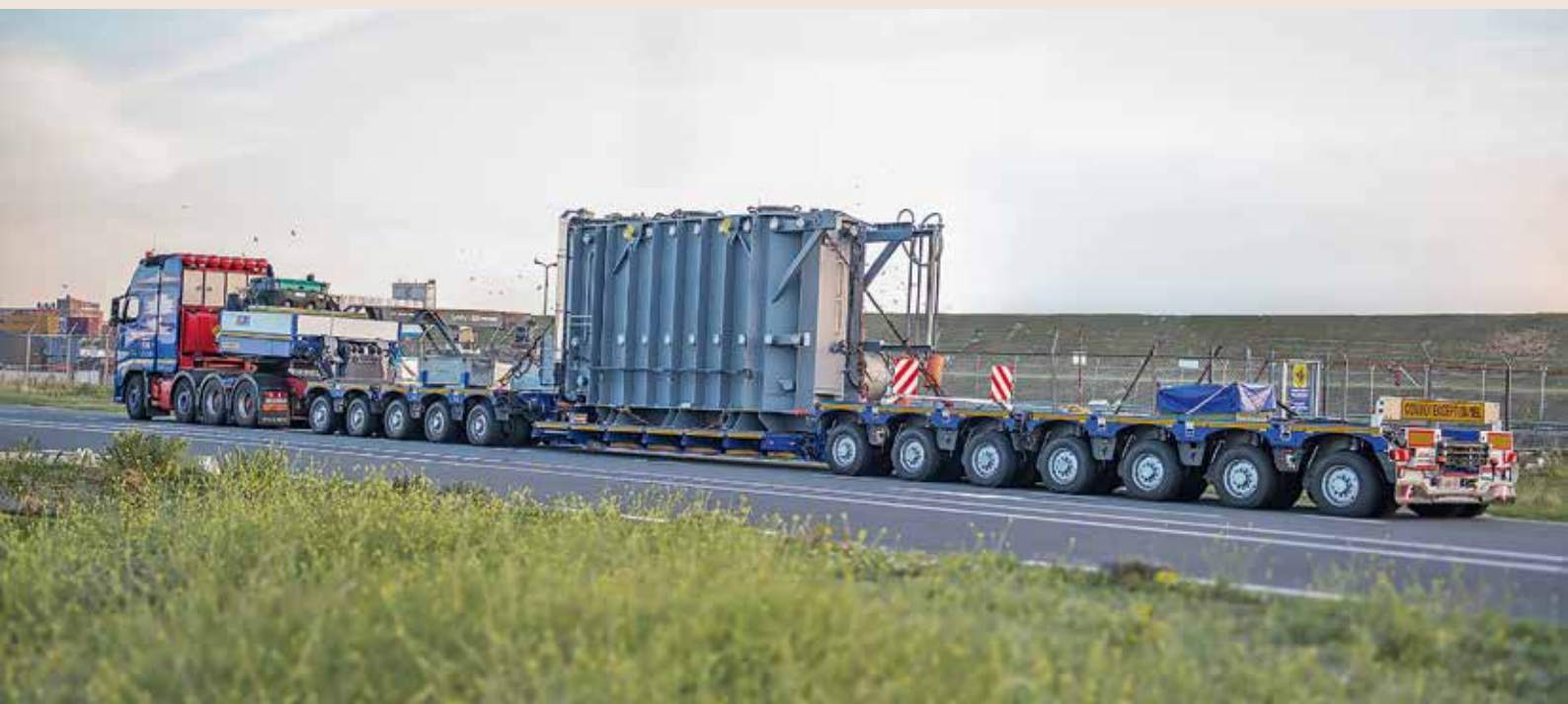
Für das Schwertransportsegment bietet gigant neben den Pendelachsen mit DLS auch ein Einzelradaufhängungssystem.
