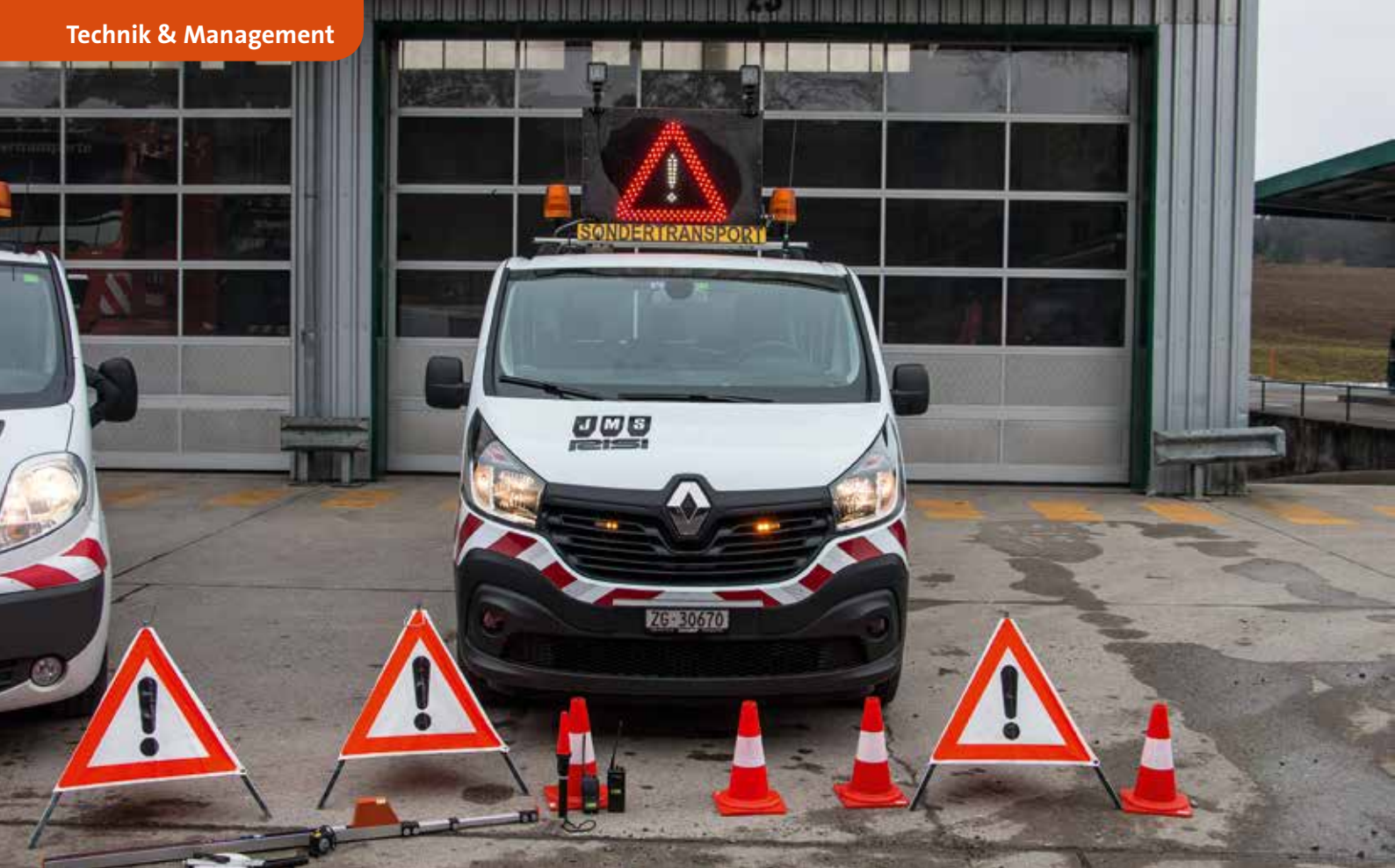
Das Schild Sondertransport und die Wechsellichtzeichenanlage, müssen von vorne und hinten sichtbar sein.
