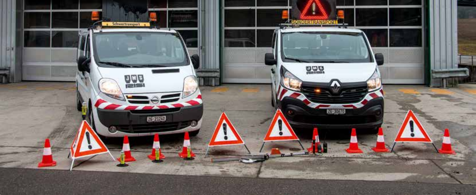
Begleitfahrzeuge mit dem Minimum an Material, welches mitgeführt werden muss. Abgesehen von den Trioplanen, welche nur zweimal vorhanden sein müssen, muss sämtliches hier sichtbares Material mitgeführt werden.
