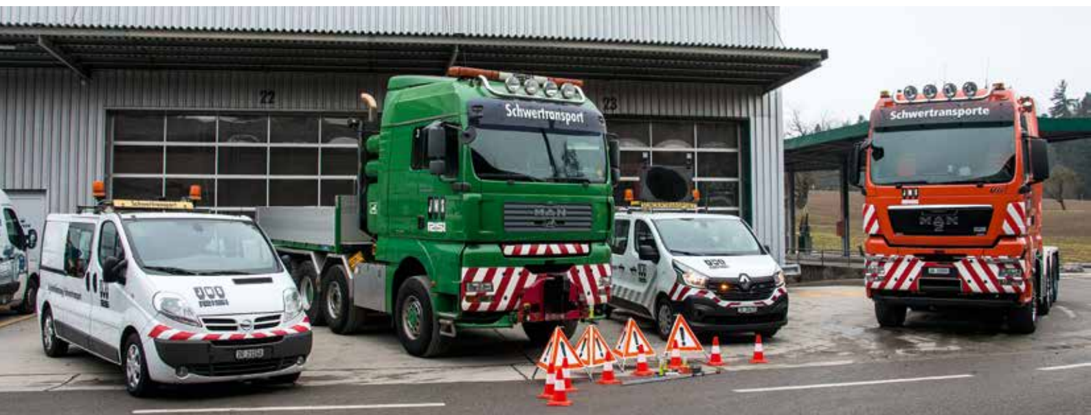
Im Bild v. l. n. r.: Begleitfahrzeug in „nicht Begleitfahrstellung“, 8x6-Zugmaschine, Begleitfahrzeug in Begleitfahrstellung und nochmals eine typische Schweizerische Schwerlastzugmaschine in 8x6-Ausführung.
