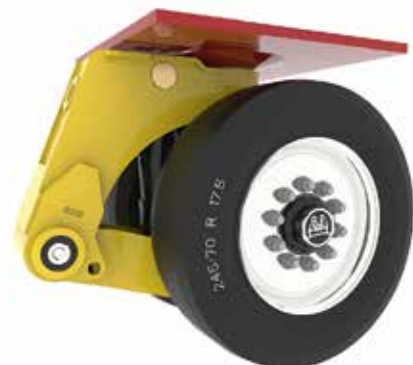
Die Broshuis-Pendelachse der zweiten Generation bietet 550 mm Hub und eine Bodenfreiheit von 810 mm.
