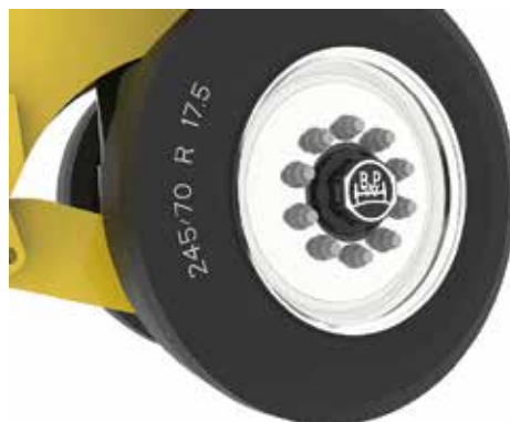
Das neue Pendelachssystem PL2 bietet im Vergleich Einzelradaufhängung 50 % mehr Hub.
