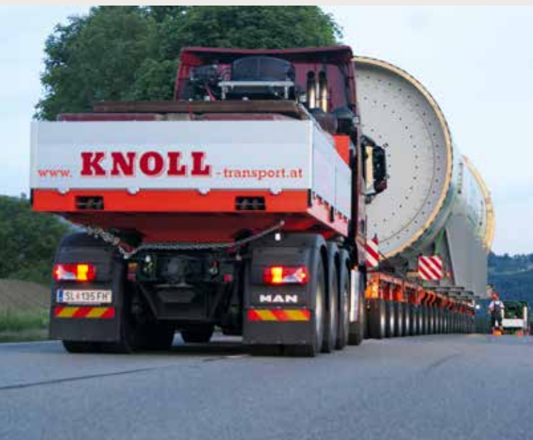
Im Zug-Schub-Verbund maß der Transport satte 55 m.
