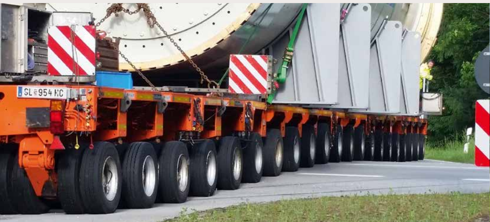
Eine ungewöhnliche Kombination aus Goldhofer- und Kamag-Achslinien brachte Knoll zum Einsatz.
