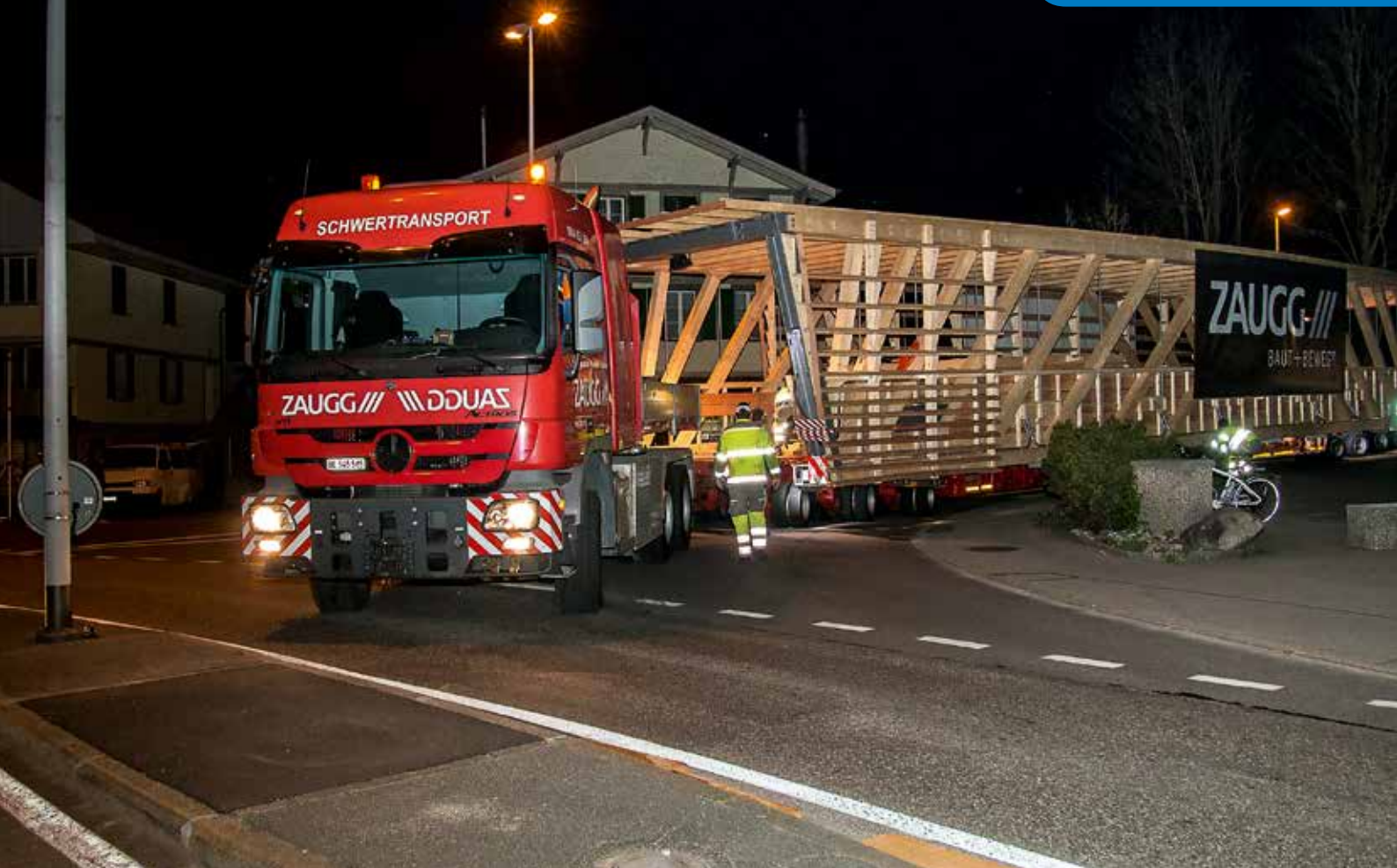
Beim Bahnhof Hasle-Rüegsau muss rechts abgebogen werden. Der Randstein der Verkehrsinsel musste dafür mit Holz umbaut werden, um die Reifen zu schonen.
