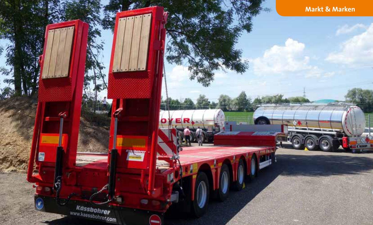
Kässbohrer Semi-Tiefflader mit Auffahrampen für den Maschinentransport.
