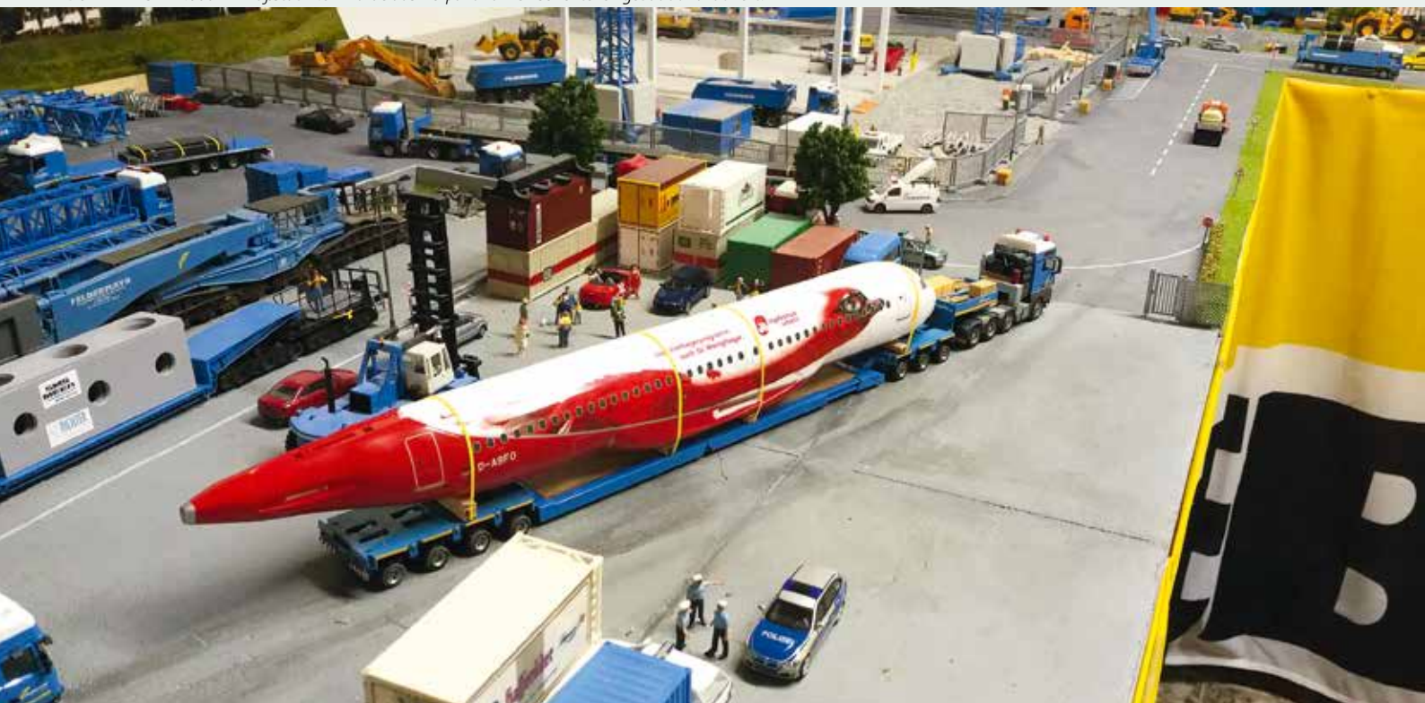
Die Goldhofer Kesselbettkombination wurde mit einem Zwischenstück verlängert, um den Rumpf des Herpa Wings 1:100 Airbus 320-200 gut unterbauen zu können. Der Rumpf wurde dann noch mit Spanngurten gesichert.
