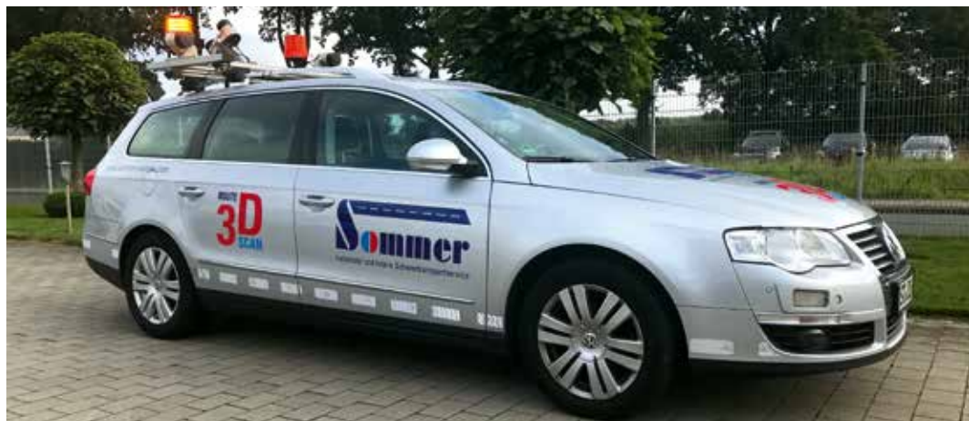
Messfahrzeug mit GPS Modul und 4 Lasern der Firma Sick.
