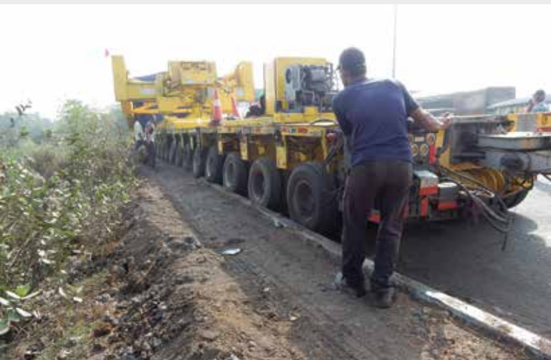
Hier wird eine Mautstation umfahren, und weil die Topografie ungeeignet war für einen Schwertransport dieses Ausmaßes, wurde das abschüssige Gelände extra aufgeschüttet. Zudem musste für das Überfahren von 25 cm hohen Randseiten ein Bypass gelegt werden.
