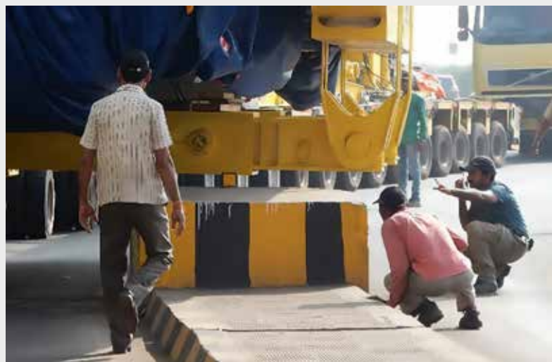
Hier wird eine Mautstation umfahren, und weil die Topografie ungeeignet war für einen Schwertransport dieses Ausmaßes, wurde das abschüssige Gelände extra aufgeschüttet. Zudem musste für das Überfahren von 25 cm hohen Randseiten ein Bypass gelegt werden.
