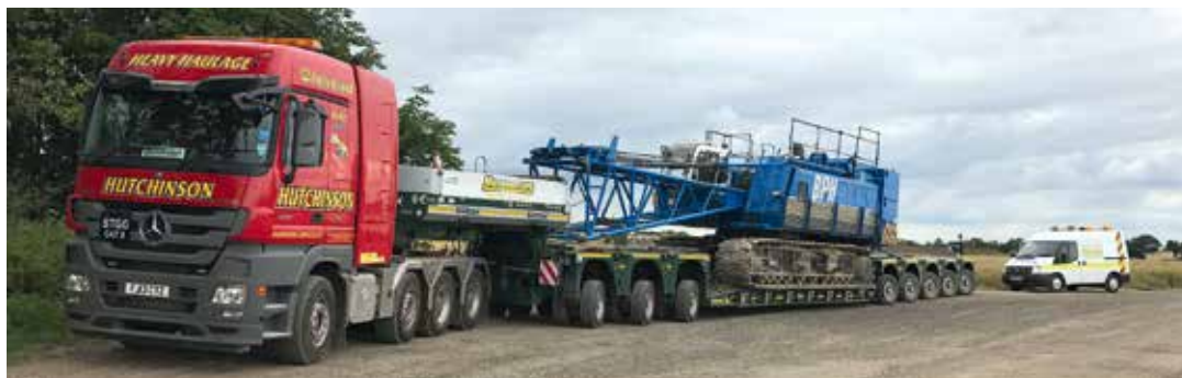
Kraftpaket und Alleskönner in einem: der STZ-VP 8 von Goldhofer – hier beim Transport eines 90 t schweren Krans.
