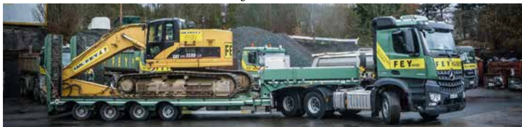
Bei Karl Fey Haiger wird der flexible 4-Achs-Semi von Faymonville sowohl Baumaschinen (Rauhen, Bagger, Walzen) als auch Baustelleneinrichtungen (Container, Bauwagen, Verbauplatten) bewegen.
