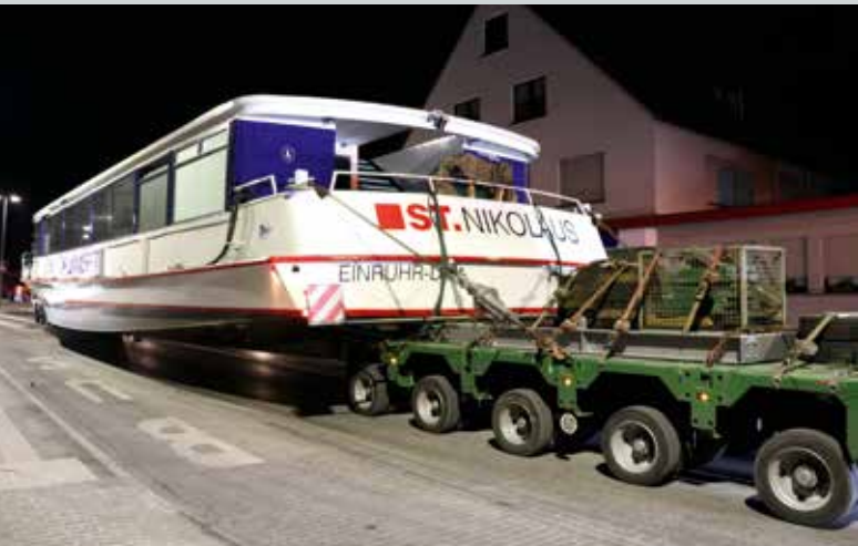
Um unter Brücken hindurchzupassen, wurde das Schiff zwischen den Achsmodulen eingehängt.
