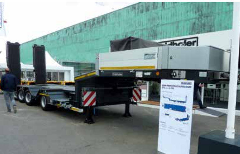
Der STZ-L4 mit Radmulde wurde von Goldhofer speziell an den Anforderungen großer selbstfahrender Baumaschinen ausgerichtet. Zudem zeigte das Unternehmen den ADDRIVE 6.
