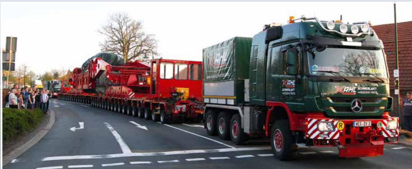
93,5 m Gesamtlänge, 592 t Gesamtgewicht: Für diesen Trafo-Transport mit der 600 t-Scherenhubbrücke G 2 K erhielt Kahl und Jansen Logistics den Award für Transporte über 120 t Gesamtgewicht. Bild: Jens Hadel
