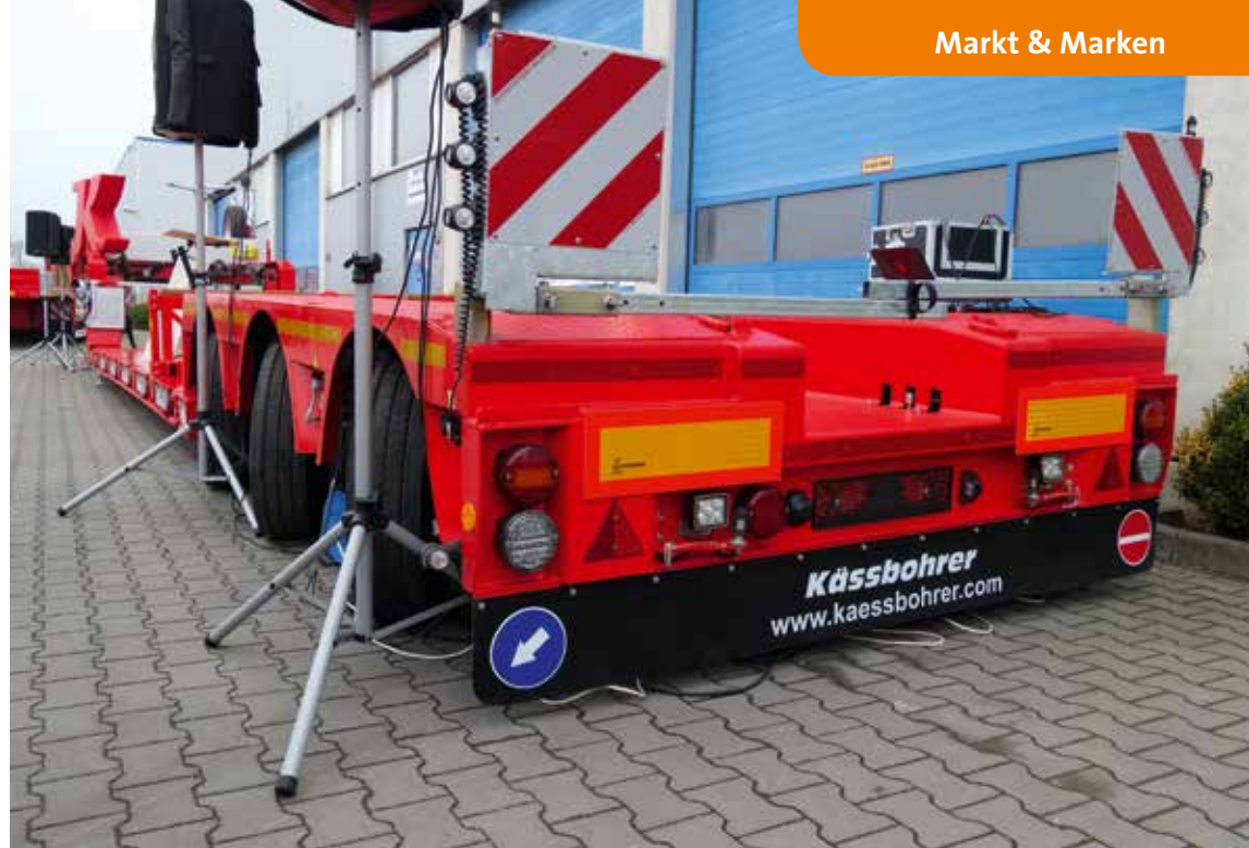
Bei den Achssystemen bietet Kässbohrer Achsen mit Achslinienlasten von bis zu 12 t wie bei diesem Tiefbettfahrzeug.
