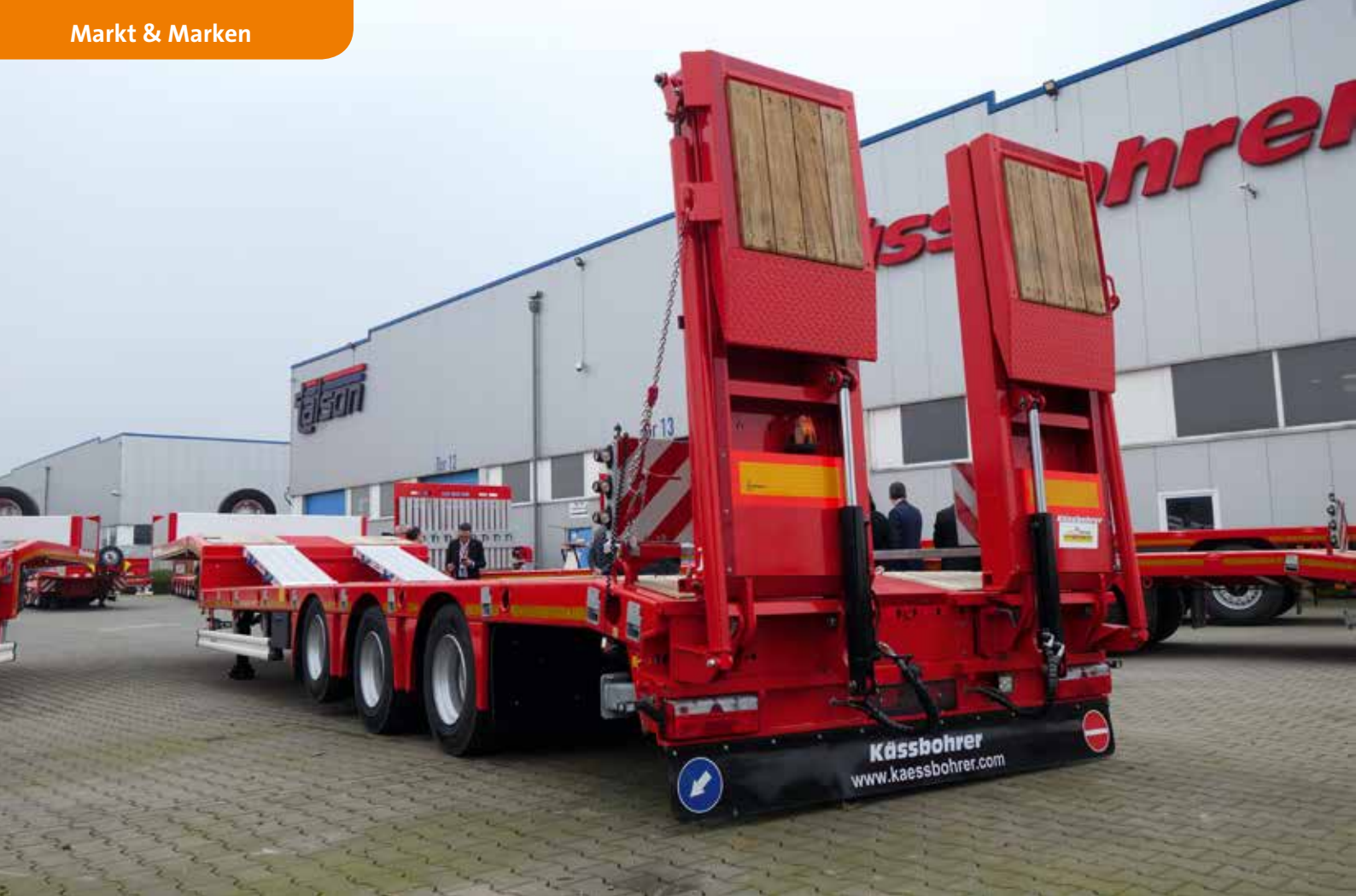
Kässbohrer bietet für seine Auflieger unterschiedliche Rampensysteme.
