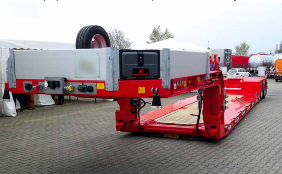
Tieflader mit leichtem und abfahrbarem Schwanenhals.
