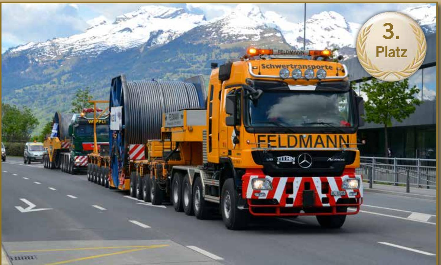
Einsatz an der Zugspitze und auf Platz 3: Feldmann mit dem „Tandemtransport“ mit „verteilter Last“. So gelangen die Seile für die Zugspitzbahn im Ganzen und – aus Brückentragfähigkeitsgründen – dennoch auf zwei Bobinen und zwei Transporteinheiten verteilt, aus der Schweiz nach Deutschland. Jeder dieser „Tandemtransporte“ bringt es auf ein Gesamtgewicht von 252 t und eine Länge von 54,4 m.
