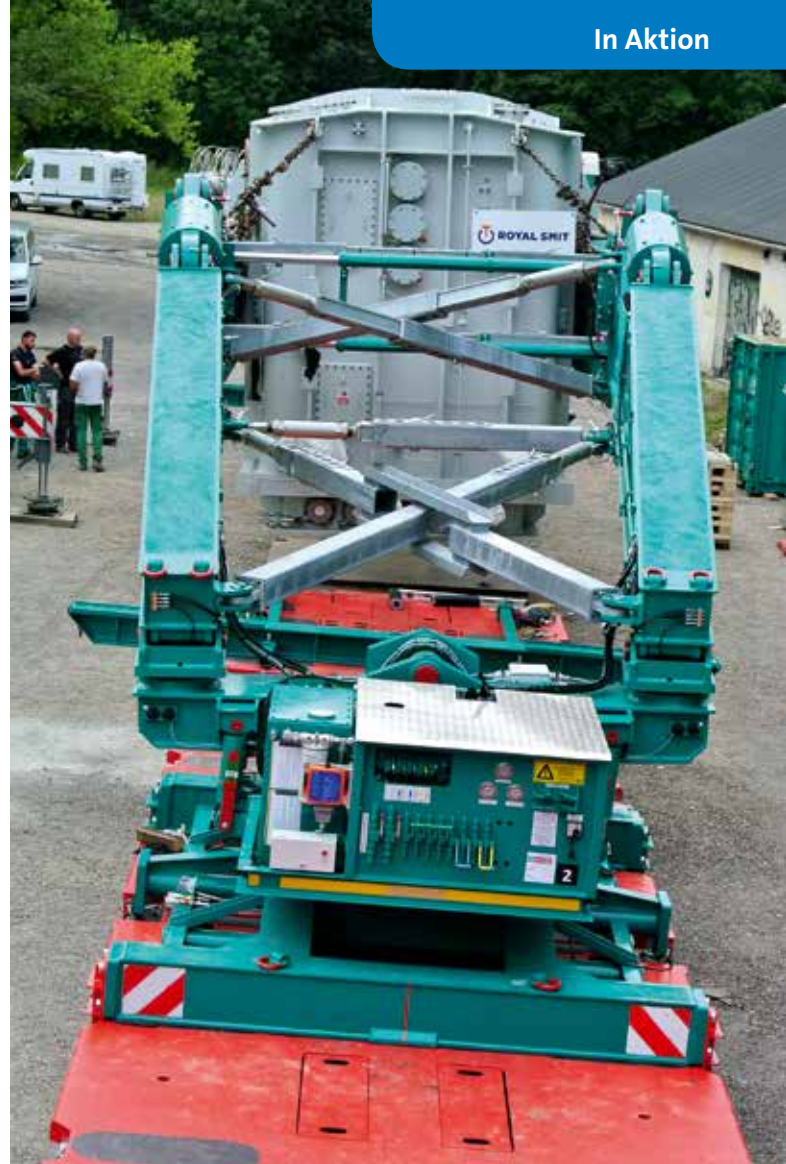
Die Verbreiterung erfolgt stufenlos hydraulisch.
