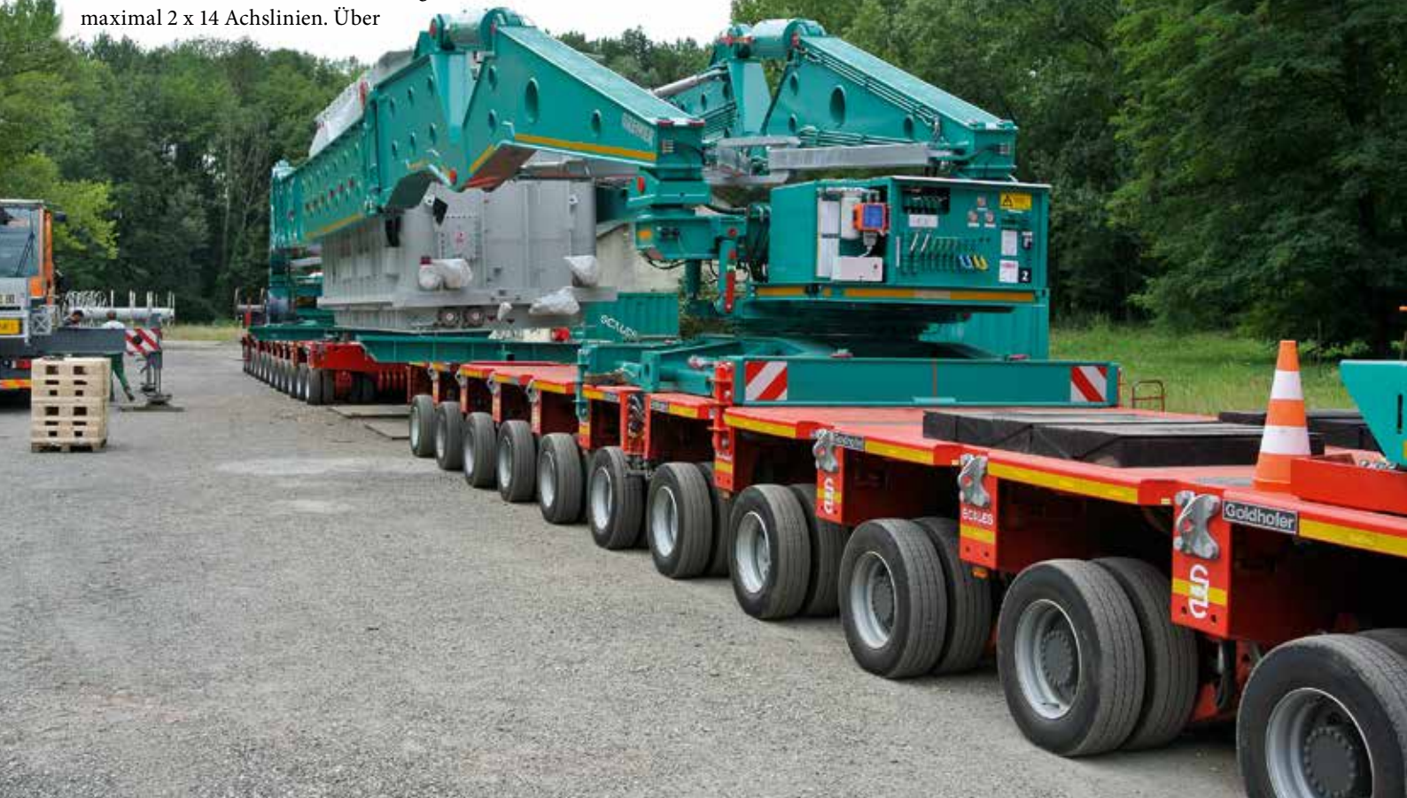
Bei der Premierenfahrt wurde ein 210 t schwerer Royal SGB-SMIT Transformator transportiert.
