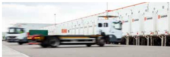
Der Kamag-Wiesel beziehungsweise Truckwiesel ist für den Transport von Wechselbrücken und Sattelanhängern innerhalb eines Logistikhofes oder Terminals konzipiert.
