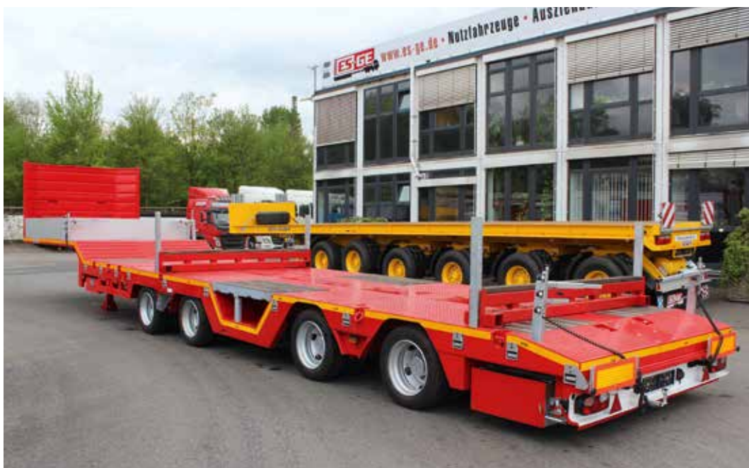
Neben vielen weiteren Fahrzeugen zeigt die ES-GE diesen 4-achsigen Auflieger mit circa 11.780 kg Eigengewicht.
