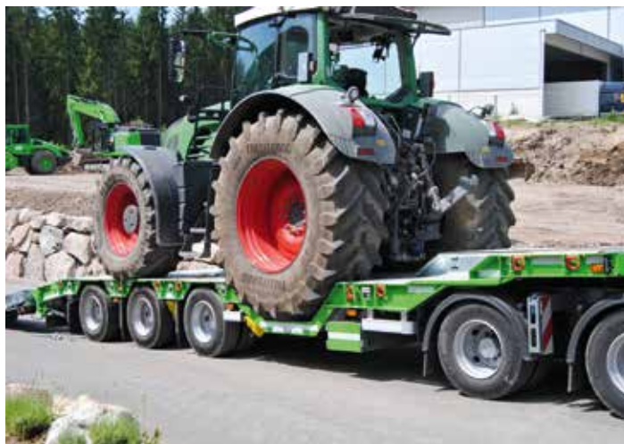
Der 5-Achs-Tiefladeanhänger mit Radmulde ermöglicht über 40 t Nutzlast.
