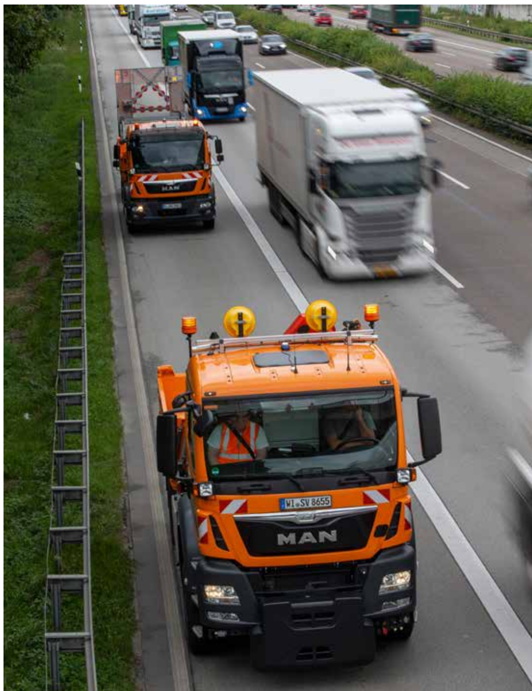
Als fahrerloses Absicherungsfahrzeug für Autobahnbaustellen im Einsatz: ein speziell ausgestatteter MAN TGM 18.430.
