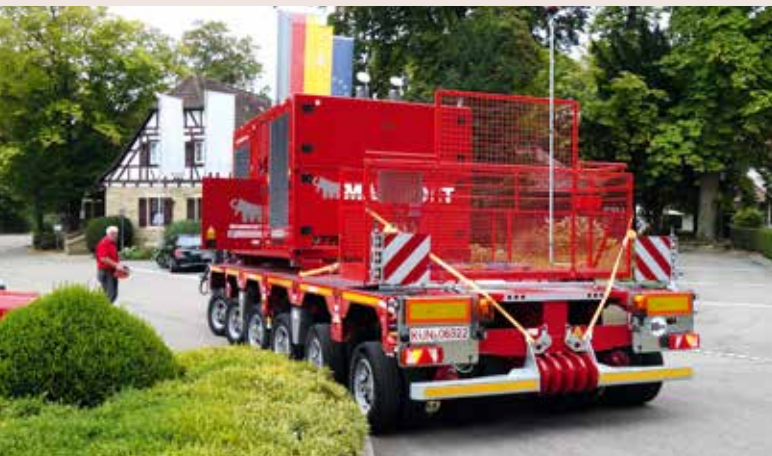
Hier wird der TPA im Selbstfahrmodus bewegt, und es werden die Kamag K25-Gene deutlich.
