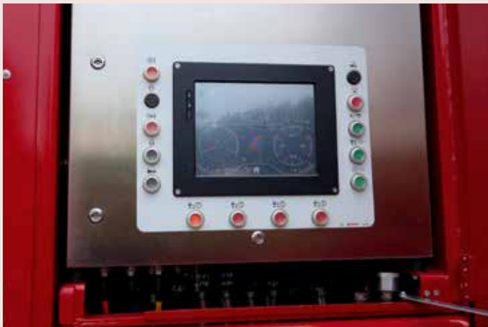
Eine ausgeklügelte Steuerungstechnik sorgt dafür, dass die Kraft des Motors gleichmäßig auf jede einzelne der vier angetriebenen Achslinien verteilt wird. STM-Bild
