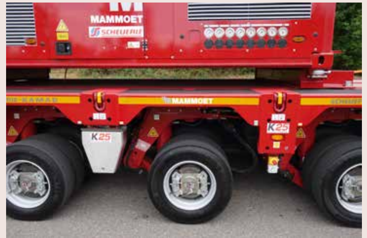
Weil die leistungsstarken Radnabenmotoren mehr Bauraum benötigen, wurden die Scheibenbremsen außenliegend angebracht. STM-Bild
