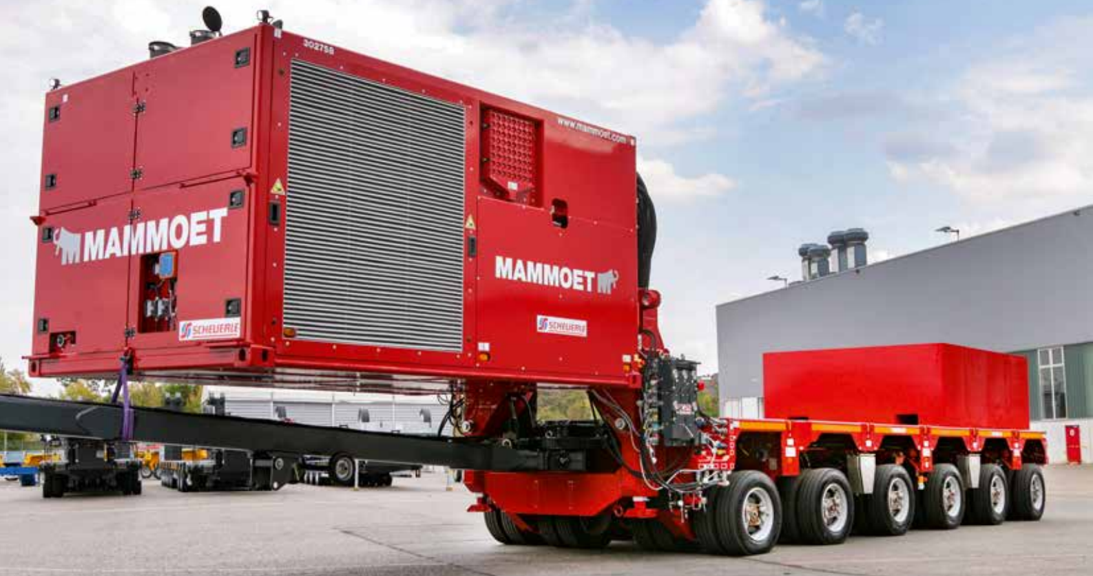
In dieser Ausstattung mit 6 Achslinien kann der TPA bis zu zwei Schwerlastzugmaschinen ersetzen.
