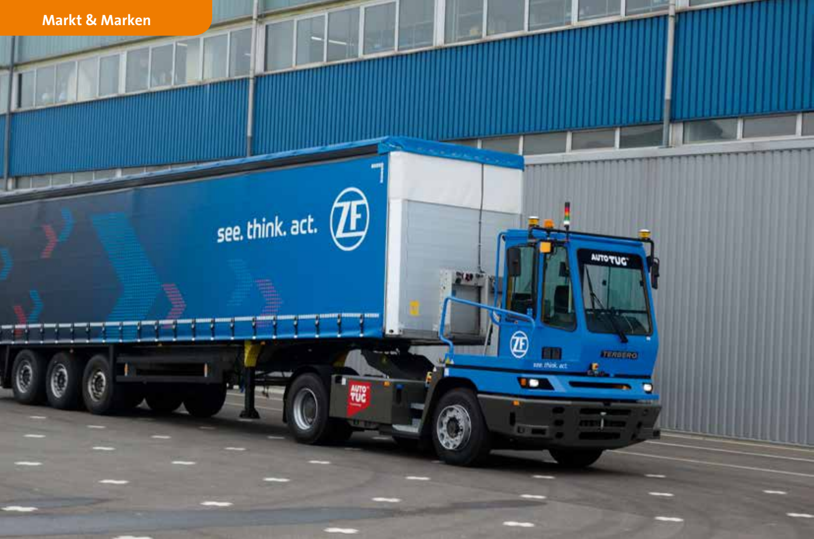
Gut zu erkennen sind die in den Boden eingelassenen Sensoren, die das Fahrzeug an eine vorherbestimmte Position leiten.
