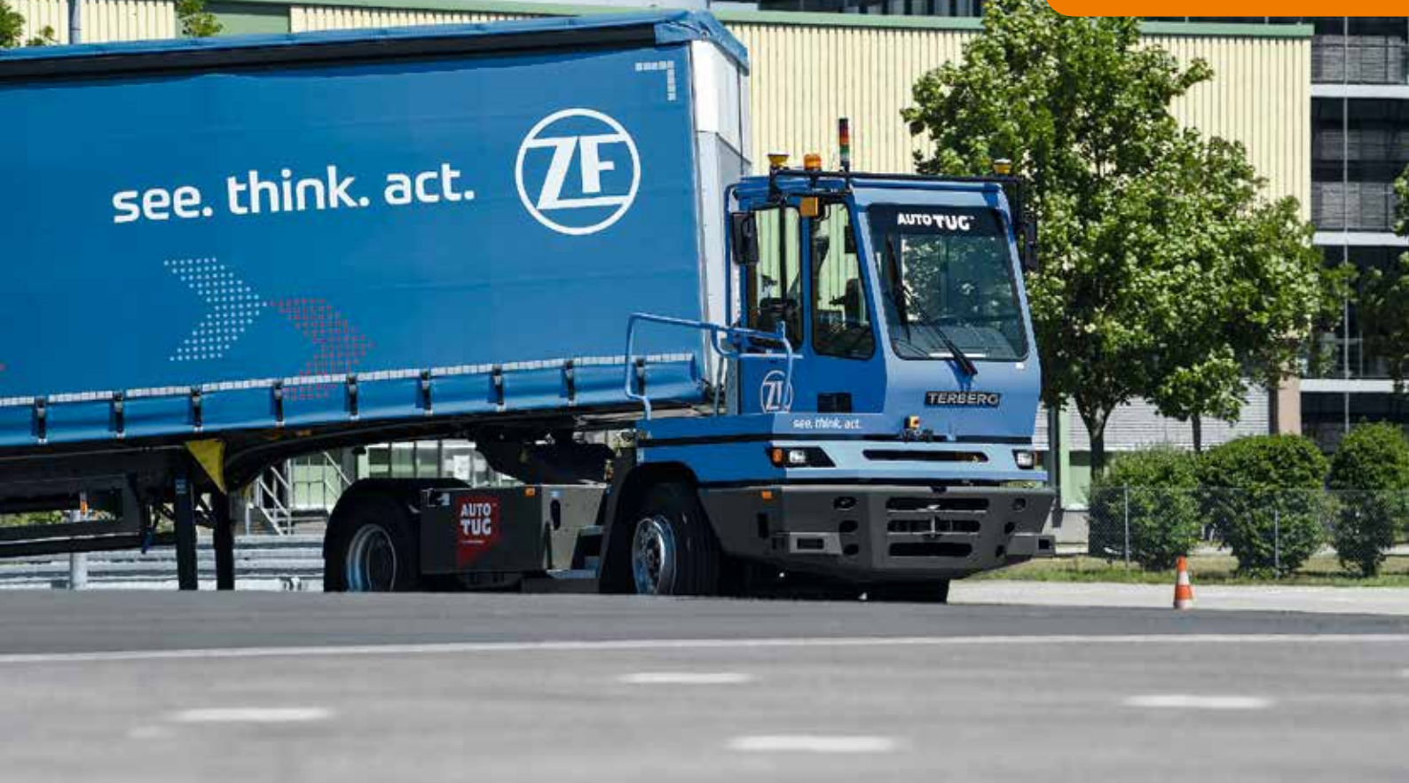
Eine Lösung für den innerbetrieblichen Transport ist dieser automatisiert fahrende Sattelschlepper, der auf Betriebshöfen Sattelaufleger rangiert.
