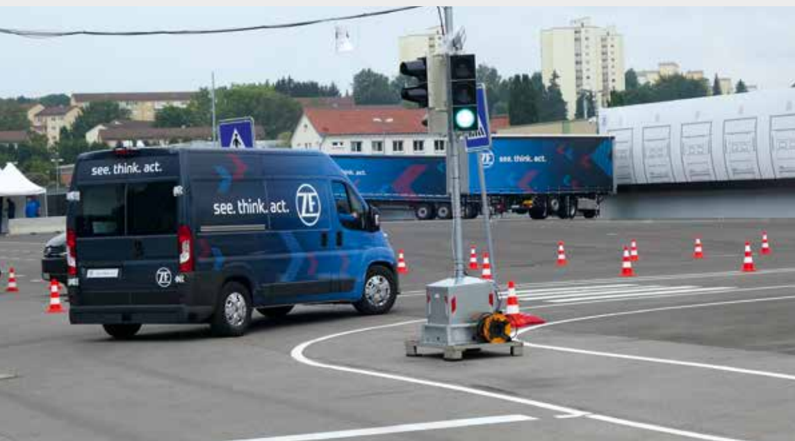
Dieses autonom fahrende Auslieferfahrzeug erkennt in diesem Parcours auch rote und grüne Ampeln und verhält sich entsprechend.
