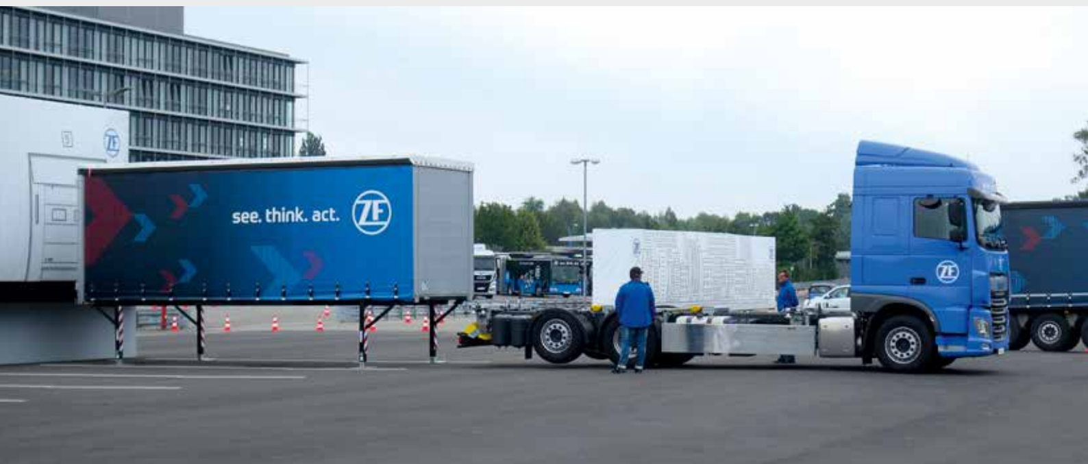
Auch das Absetzen und Aufnehmen von Wechselbrücken funktioniert schon mit autonom fahrenden Lkw.
