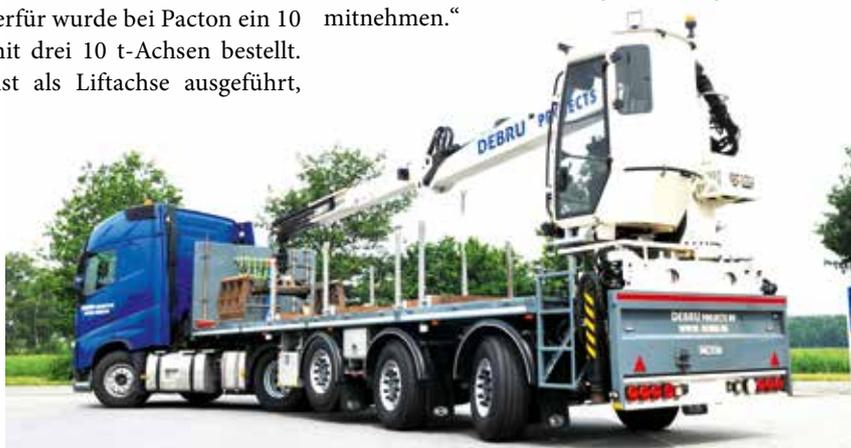
Pacton-Trailer, VSE-Lenkung, Tecma-Achsen, Marchesi-Kran: für Debru aus Groningen die perfekte Lösung um zum Beispiel Fahrbleche für Behelfsstraßen zu verlegen.
