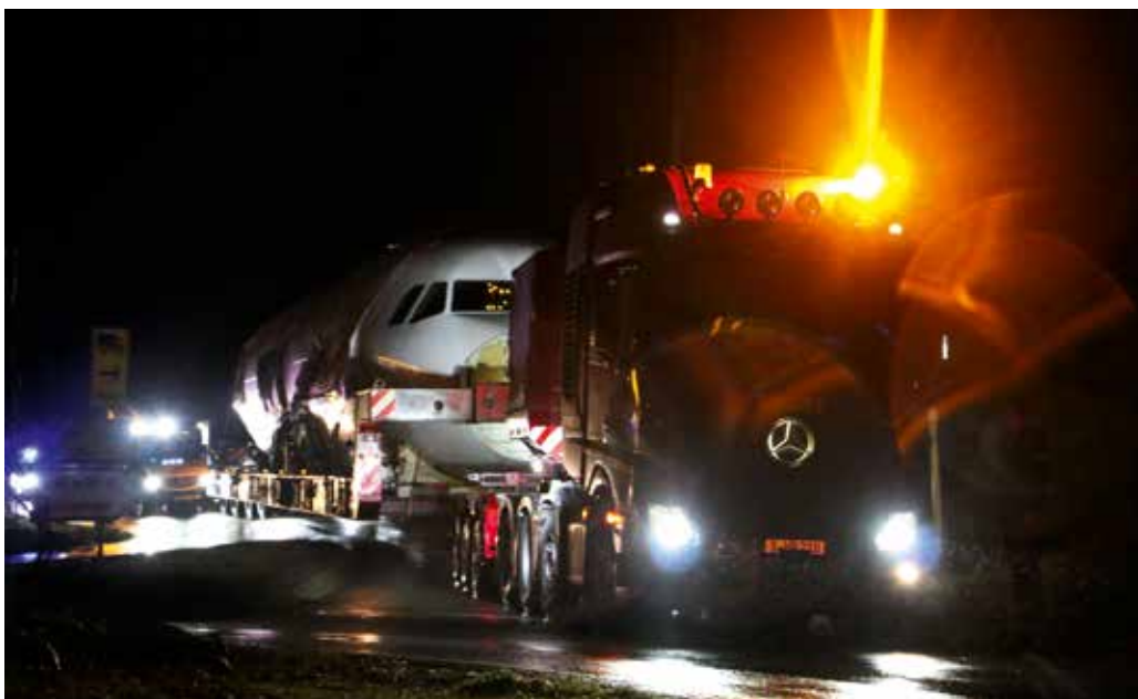
60 m lang, 90 t schwer, 5 m breit: die Abmessungen des Airbus-Transports sind beachtlich.
