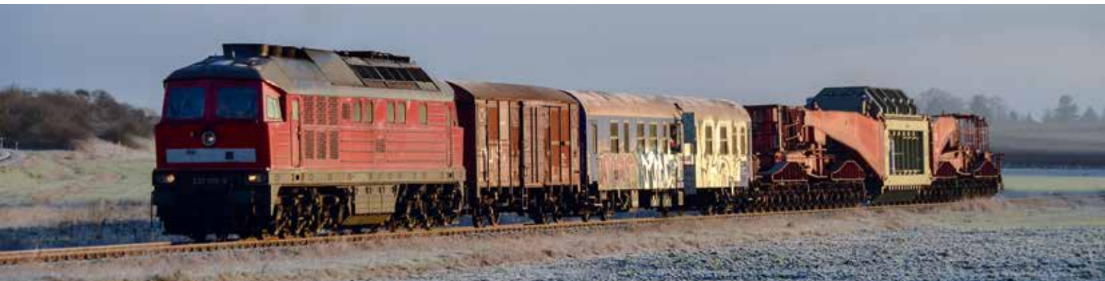
Auf der reaktivierten und verstärkten Hunsrückbahn reiste der Trafo zur Umladestelle in Stromberg.
