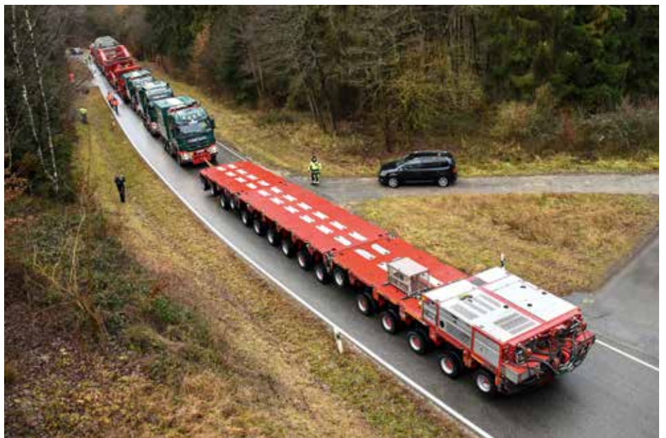
Drei Schwerlastzugmaschinen und die Power eines Selbstfahrers ziehen den Trafo über den Berg.
