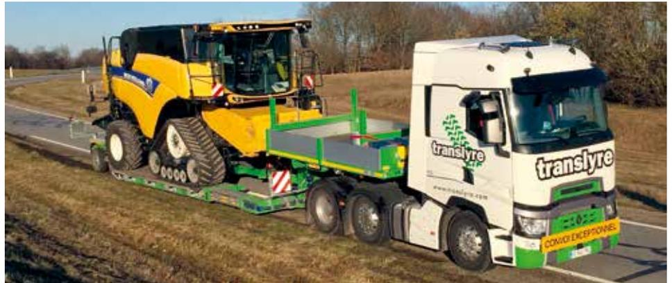
Der 2-Achs-MegaMAX bietet eine Tiefbettbreite, die zwischen 1.600 mm und 3.650 mm einstellbar ist.
