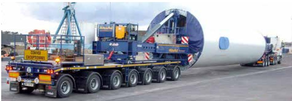
Nach 13 Jahren hat Nootboom nun das Patent für den LIFTAD, den speziellen Liftadapter für den Mega Windmill Transporter, erhalten.
