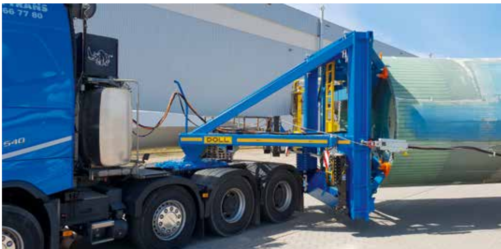
Der wechselbare Aufnahmeadapter ist auf die jüngsten Rotorblatt-Generationen der Nordex Group ausgelegt.
