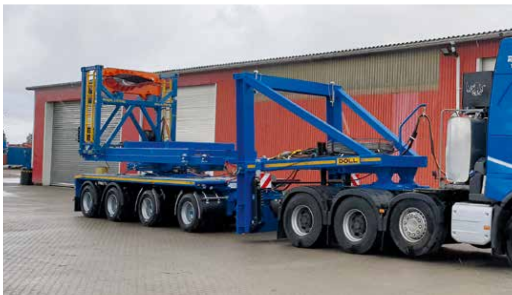
Bei Leerfahrt bilden Nachläufer, Aufnahmeadapter und Zugmaschine eine kompakte Einheit.
