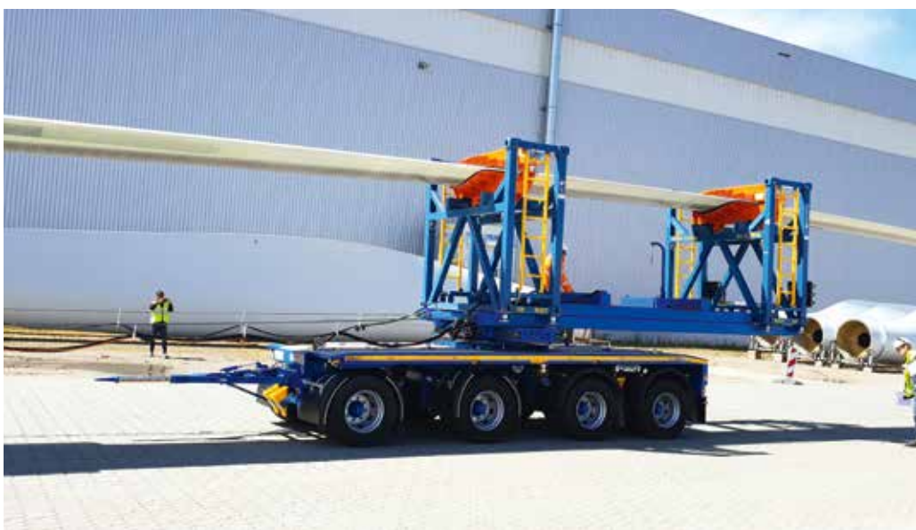
Die Flügelspitze lässt sich auf dem VARIO-Nachläufer flexibel verschieben.
