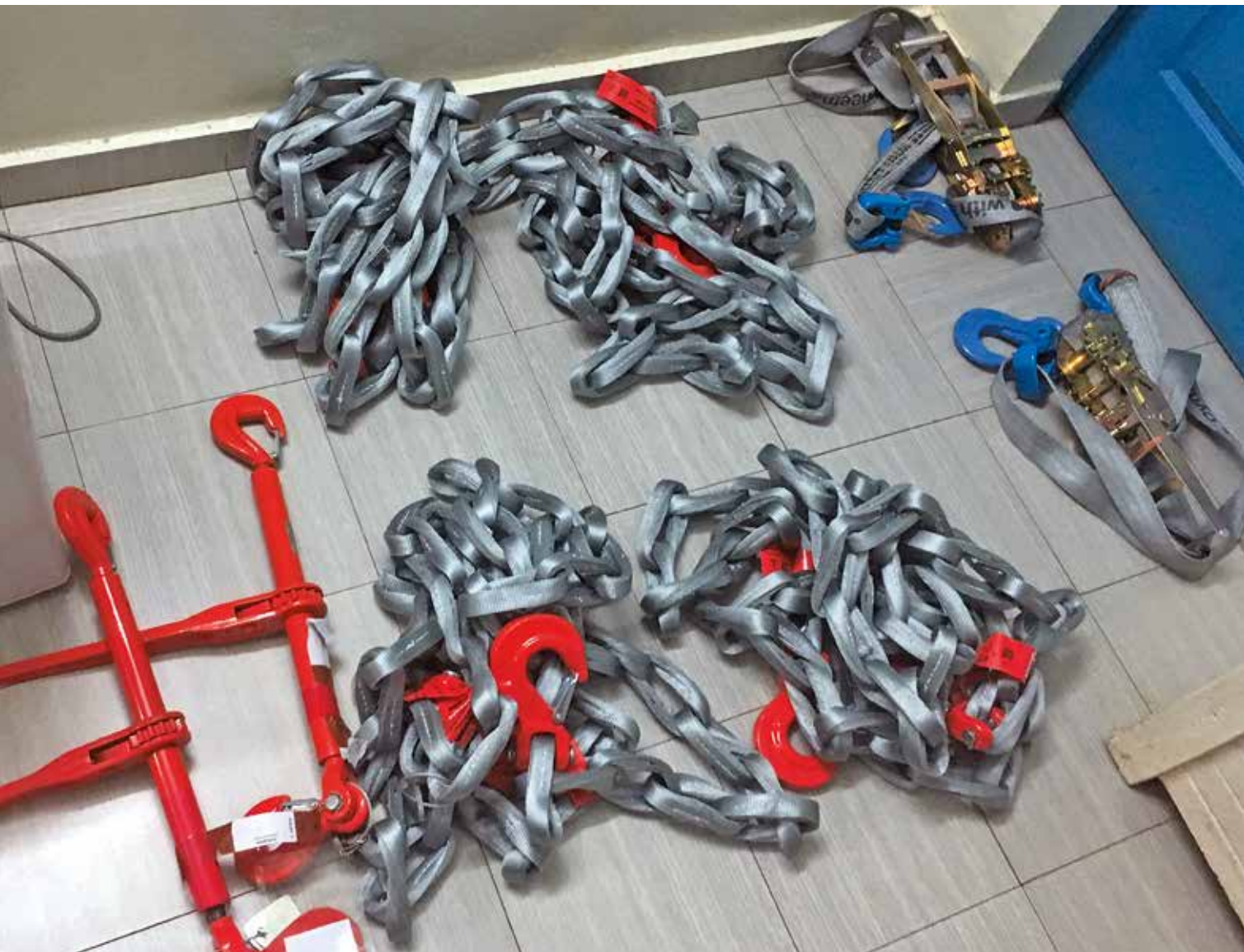
Gegenstand des Tests war die Kette mit ihren Endbeschlägen sowie der speziell entwickelte hochfeste Ratschlastspanner mit verbreitertem Hakenradius und Dyneema-Zurrgurte mit Getriebezugsrutsche, die jeweils zum Verspannen beziehungsweise Verkürzen der DoNova PowerLash genutzt werden können.
