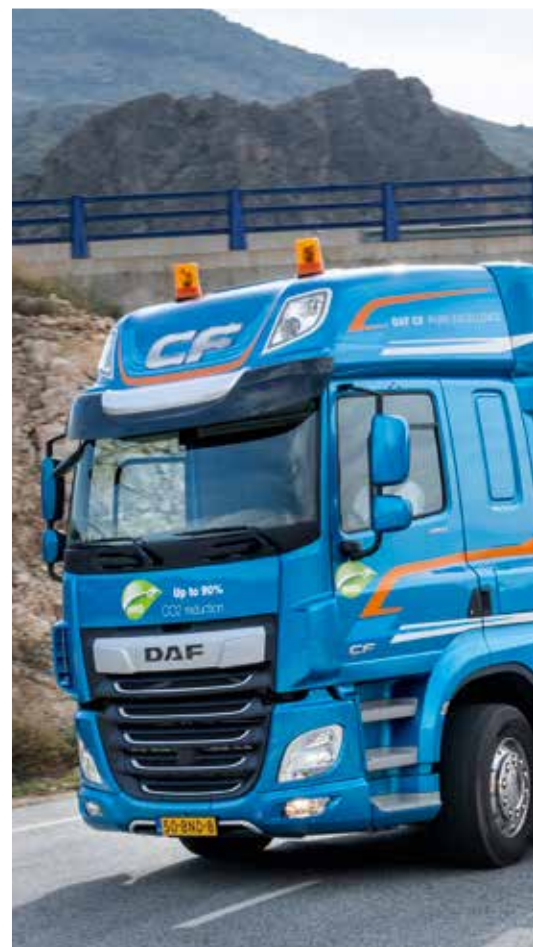
Der FAX mit zwei gelenkten Vorderachsen (8 oder 9 t) und einer gelenkten Nachlauf-Hinterachse (7,5 t) war bislang nur als CF erhältlich und kann jetzt auch als XF bestellt werden. Wie bei dem vergleichbaren CF ermöglicht der XF FAX technische Gesamtgewichte von bis zu 37 t. Im Bild: CF 480 FAX 8x2.
