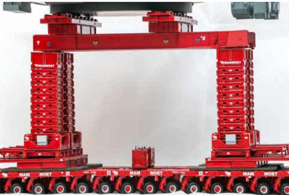
Wie im Original ist auf den Achslinien das Skidding System von Mammoet aufgebaut.
